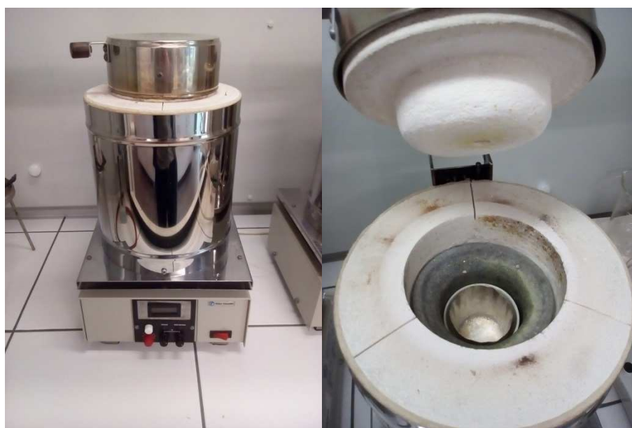
Obr. 30: Kalcinace zhomogenizované navážky oxidů v platinovém kelímku.
