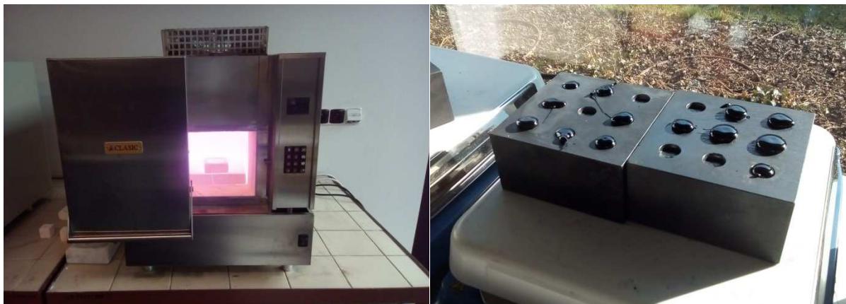
Obr. 31: Tavící muflová pec (vlevo) a vyhřívaná grafitová forma po vylití vzorku skla (vpravo).
