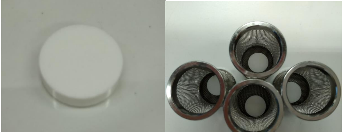
Obrázek 22: Směsná matricová tableta před disolučním testem.
