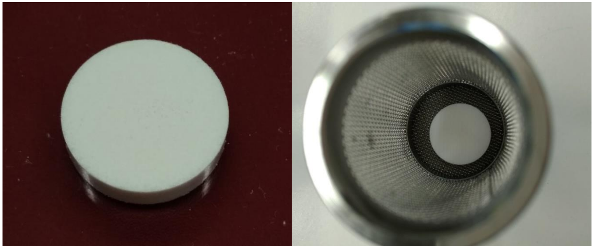
Obrázek 19: Směsná matricová tableta před disolučním testem.
