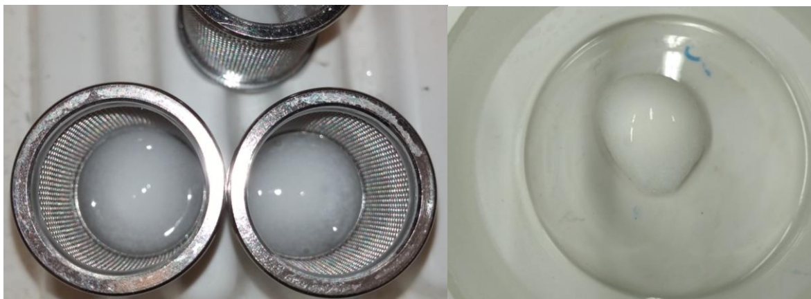
Obrázek 24: Matricová tableta po disolučním testu (24h) v hydro-alkoholickém disolučním médiu.
