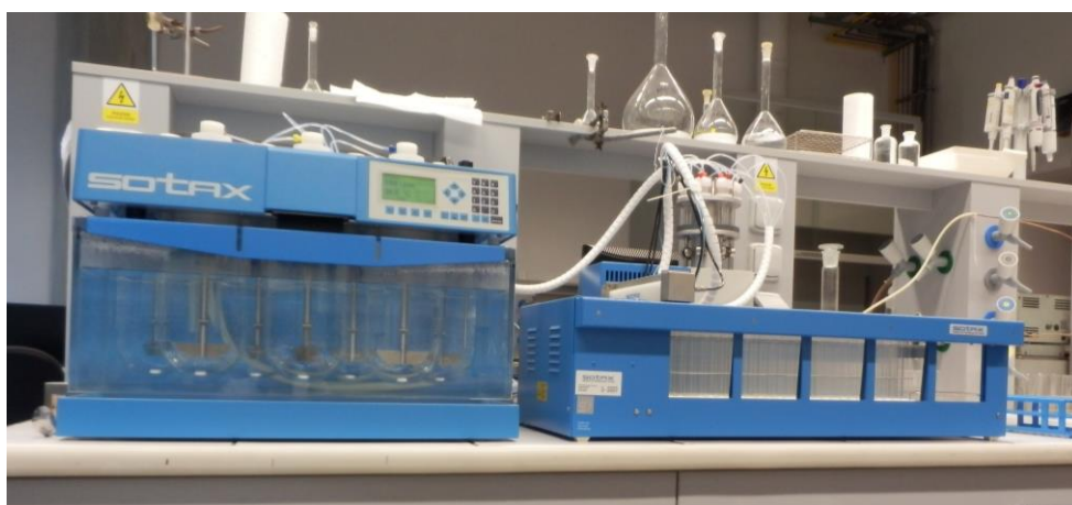
Obrázek 16: Disoluční přístroj využívaný pro disoluční testy na Katedře Fyzikální chemie.
