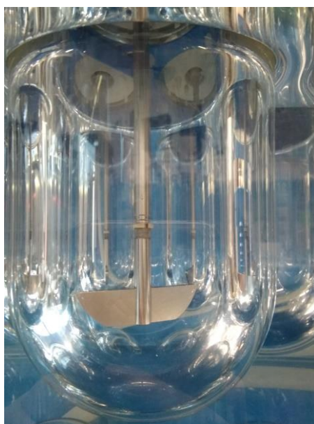
Obrázek 18: Pádélková disoluční metoda (foto pořízeno při disolučním testu prováděném pro tuto diplomovou práci).
