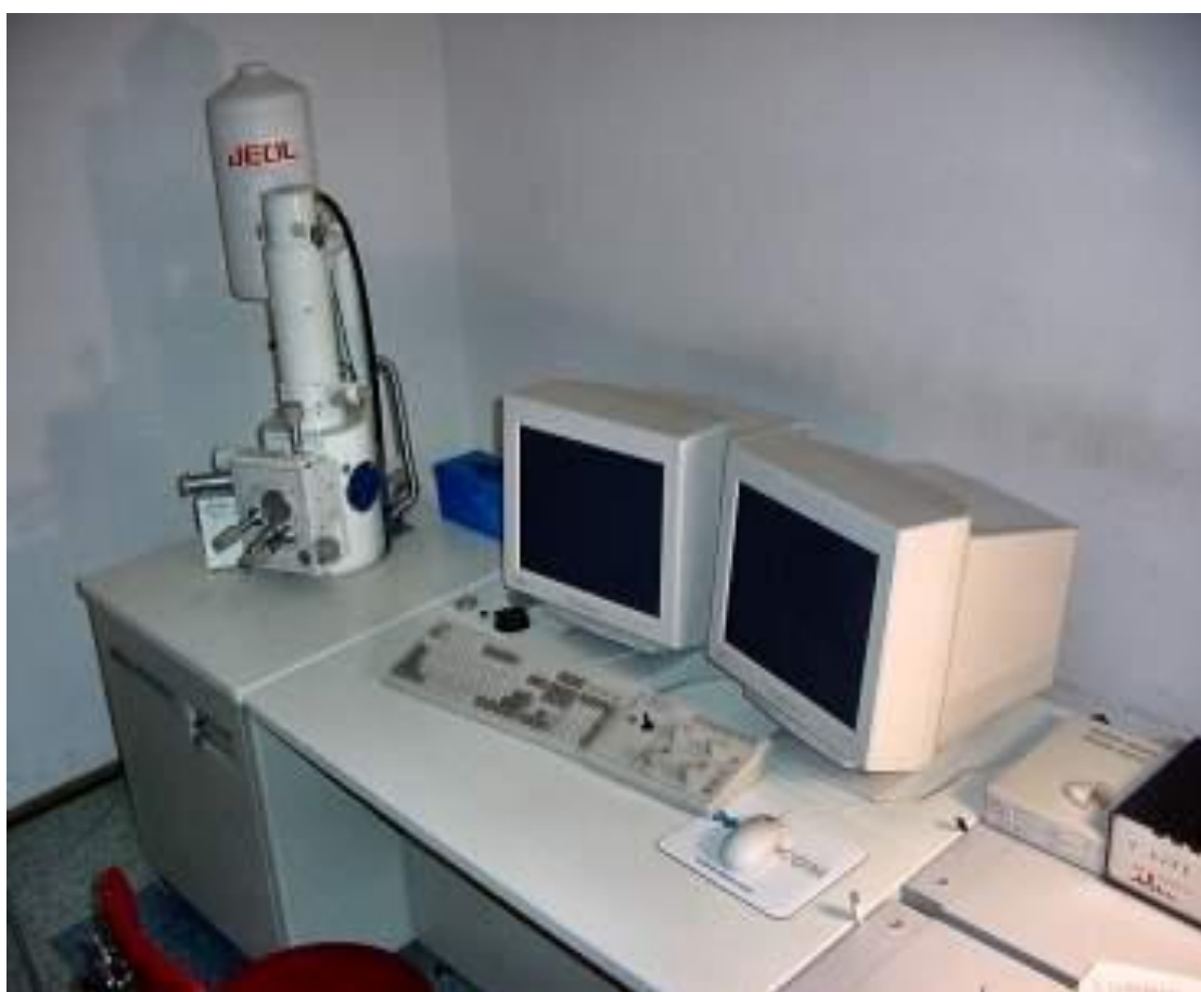
Obrázek č. 7: Skenovací elektronový mikroskop s rentgenovým energiově disperzním analyzátozem
