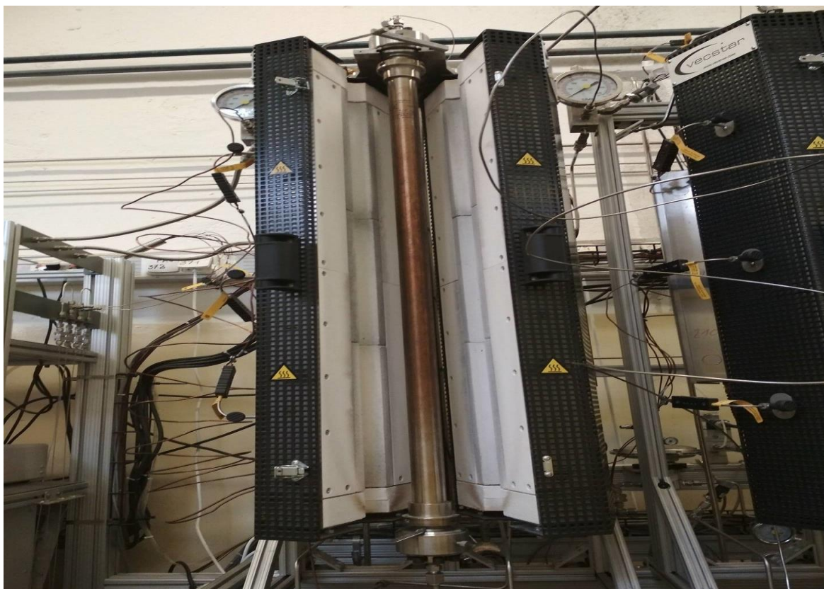
Obrázek č. 6: Průtokový trubkový reaktor s pevným ložem katalyzátor
