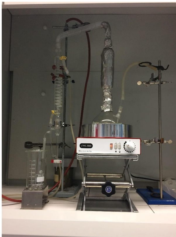
Obrázek 3: Aparatura pro parní destilaci
