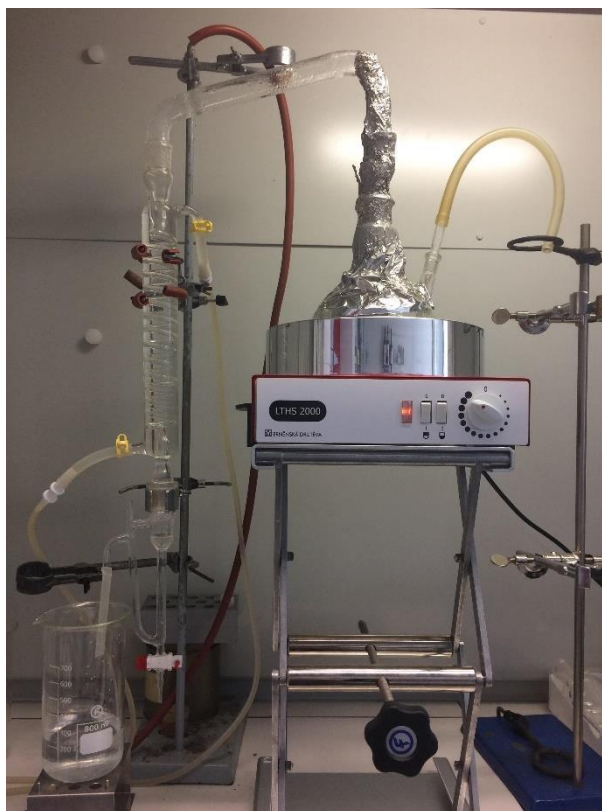
Obrázek 4: Aparatura pro hydrodestilaci
