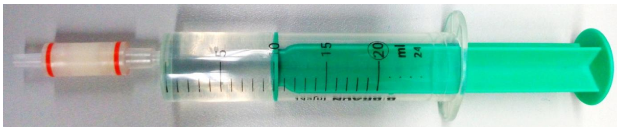
Obrázek 11 Kolonka se sorbentem Separon SGX C18 a injekční stříkačkou
