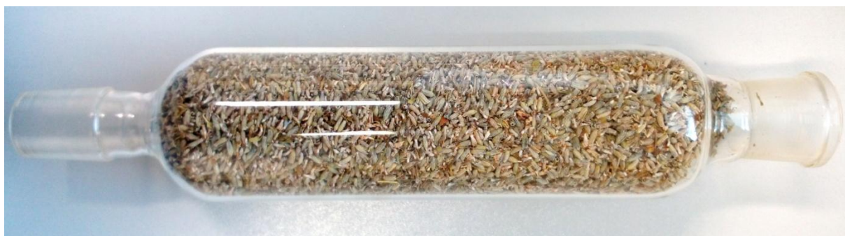
Obrázek 9 Sušený květ levandule v baňce k parní destilaci
