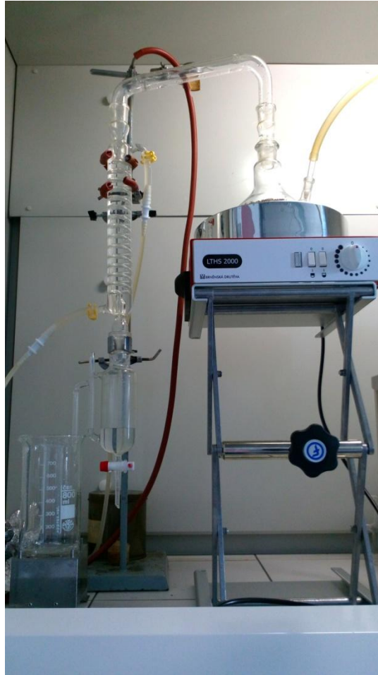
Obrázek 3 Hydrodestilace; vzorek se nachází spolu s vodou v destilační baňce
