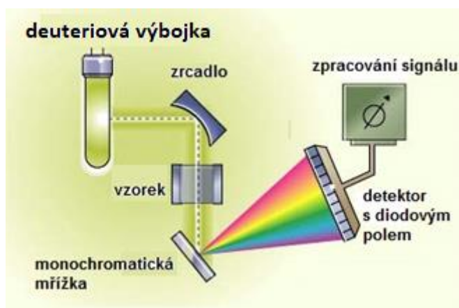
Obrázek 22: Princip detektoru s diodovým polem [63]
