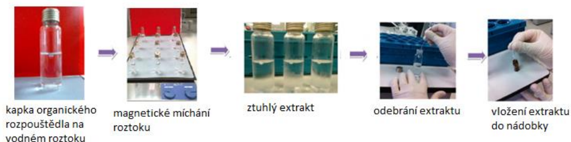
Obrázek 6: Provedení mikroextrakce využívající ztuhnutí organické kapky [17]
