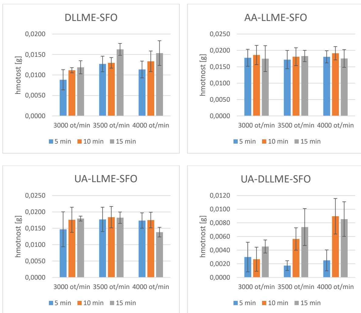
Obrázek 42: Grafy pro optimalizaci rychlosti a doby odstředění u všech extrakcí pro různé časy (n = 6) (DLLME-SFO – disperzní kapalinová mikroextrakce využívající ztunutí organické kapky, AA-LLME-SFO – vzduchem asistovaná disperzní kapalinová mikroextrakce využívající ztunutí organické kapky, UA-LLME-SFO – ultrazvukem asistovaná disperzní kapalinová mikroextrakce využívající ztunutí organické kapky, UA-DLLME-SFO – ultrazvukem asistovaná disperzní kapalinová mikroextrakce využívající ztunutí organické kapky s disperzním rozpouštědlem)
