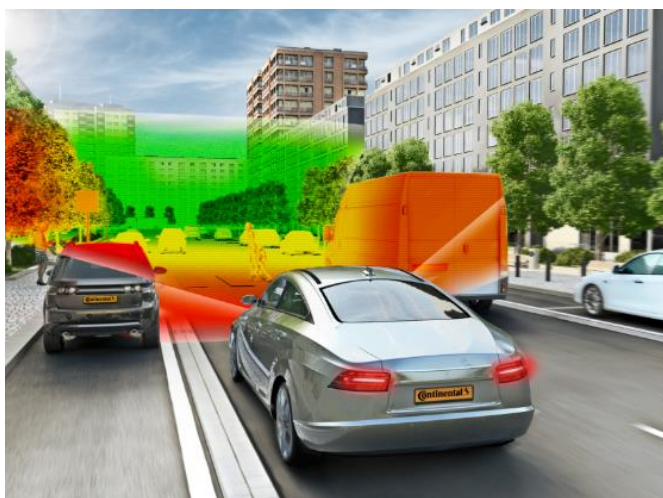
Obrázek 4.5 – Lidar jako bezpečnostní prvek automobilu (Warburton, 2017)
