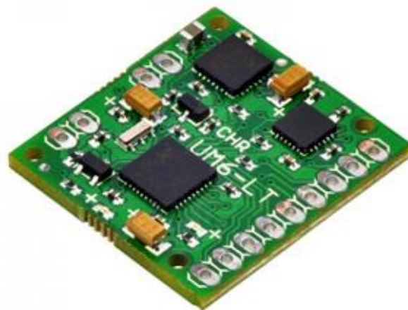
Obrázek 3.3 – IMU jednotka ( http://www.clker.com , 2018)
