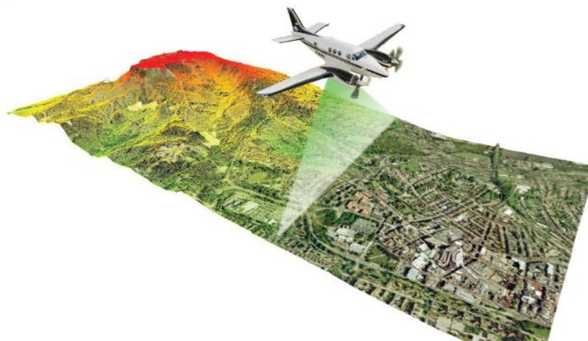
Obrázek 1.2 – Letecké skenování povrchu pomocí lidarů (3DEO, 2010)
