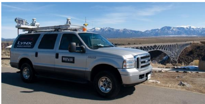
Obrázek 4.4 – Automobil s instalovaným lidarem pro snímání okolí (Howell, 2013)
