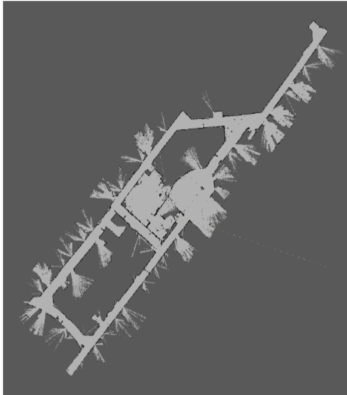
Obrázek 4.1 – Obrázek 2D mapy získaný pomocí metody SLAM (Noury, 2013)
