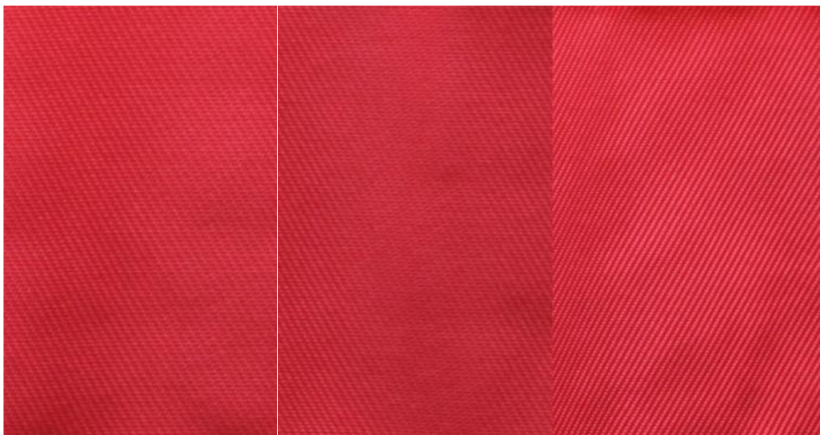
Obrázek 16: Rybacidová červeň E barvená klasickým způsobem, enkapsulovaná v inertní atmosféře, enkapsulovaná na vzduchu
