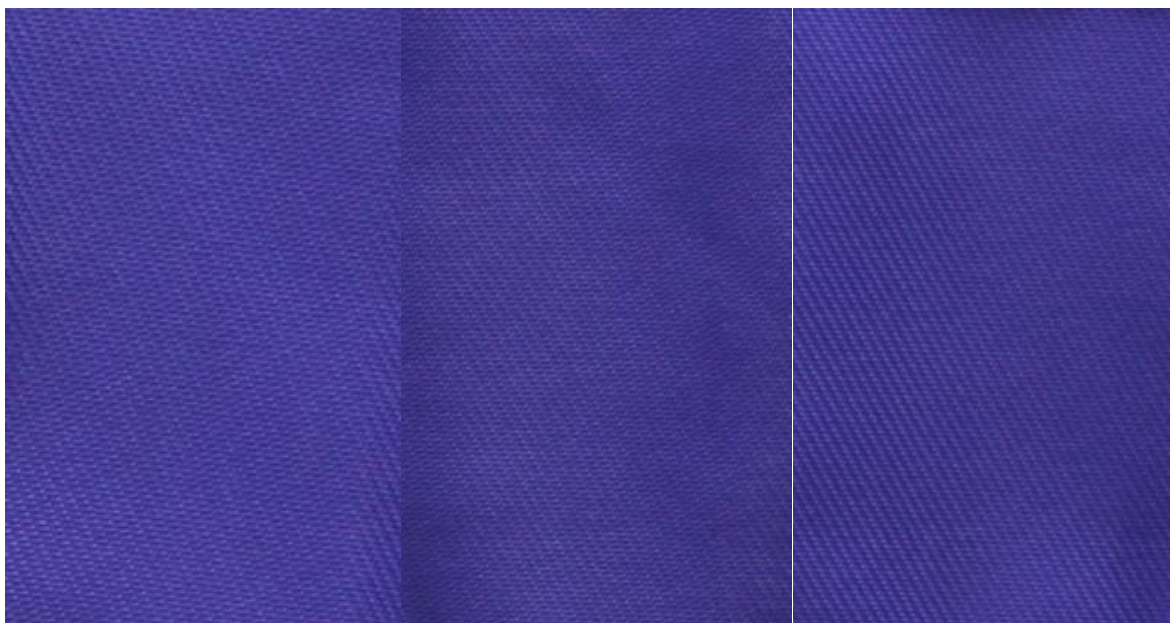
Obrázek 20: Egacidová violet' 3B barvená klasickým způsobem, enkapsulovaná v inertní atmosféře, enkapsulovaná na vzduchu
