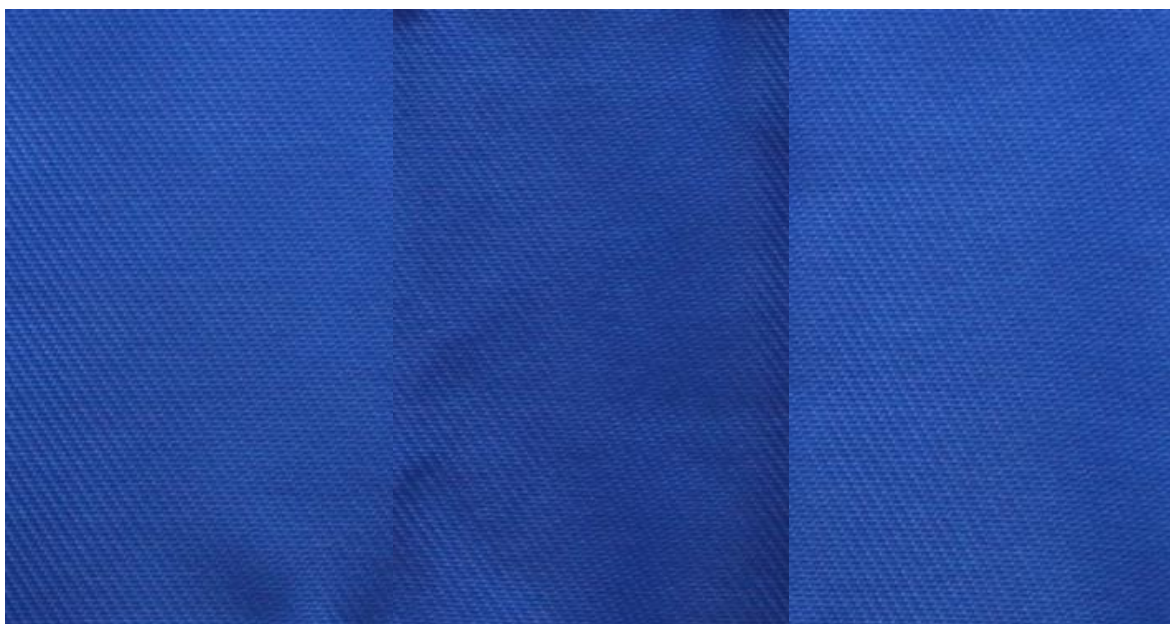
Obrázek 19: Egacidová modř K barvená klasickým způsobem, enkapsulovaná v inertní atmosféře, enkapsulovaná na vzduchu
