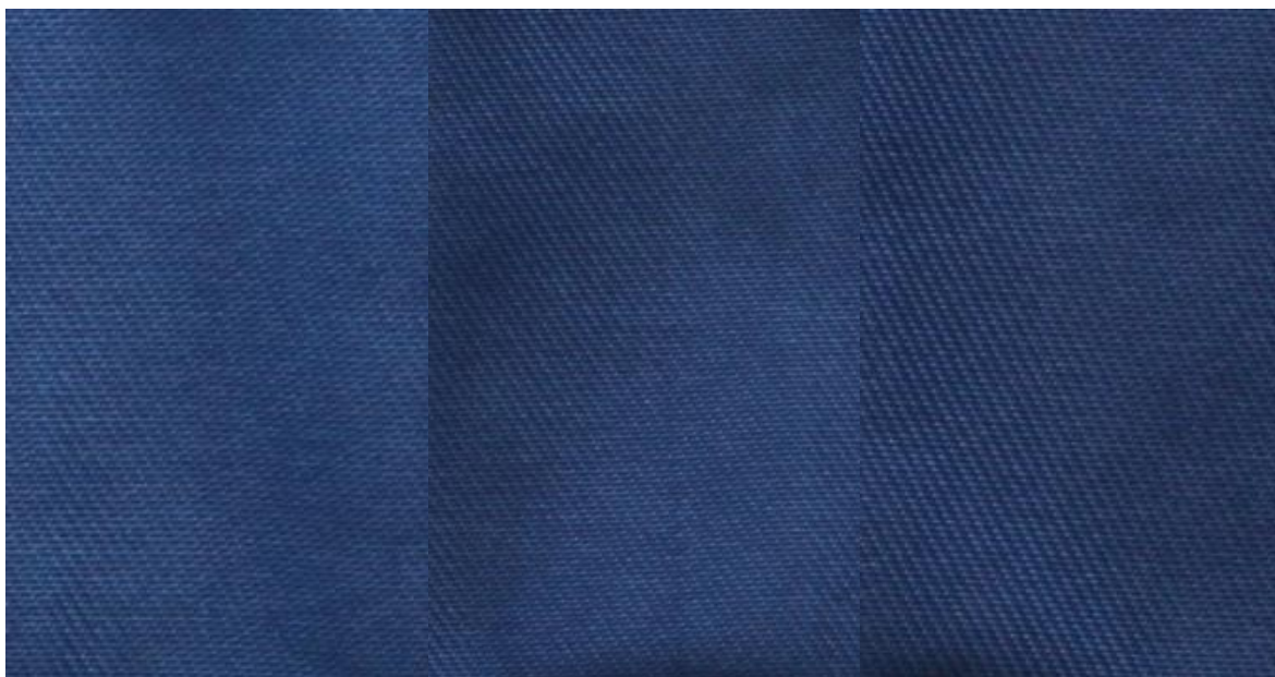
Obrázek 18: Rybacidová modř 5R barvená klasickým způsobem, enkapsulovaná v inertní atmosféře, enkapsulovaná na vzduchu
