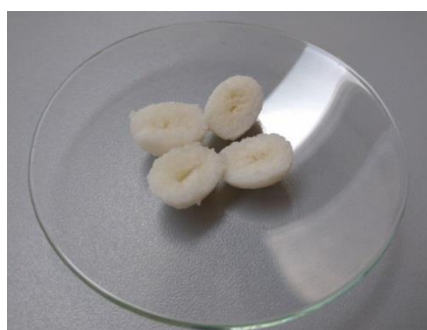
Obrázek 19- Tablety s alginátem po 24 hodinách v AGF a jejich průřez
