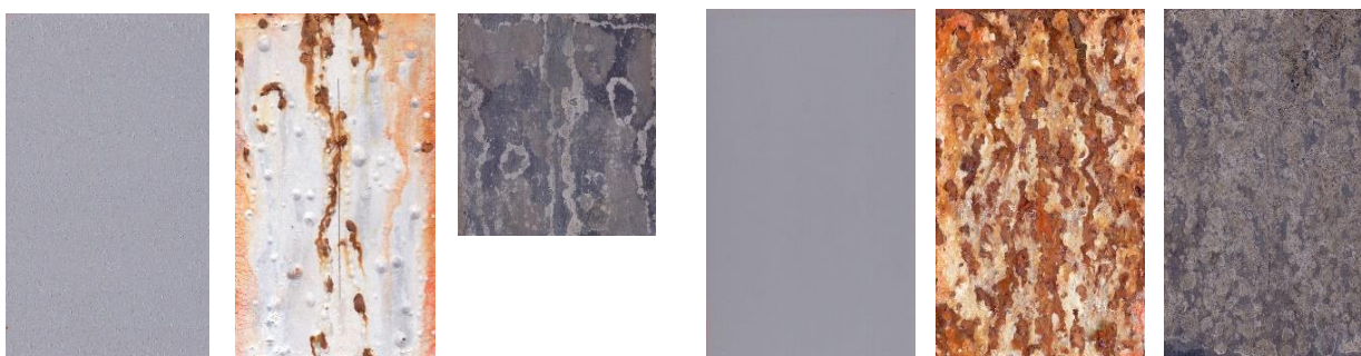
Obrázek 34: vlevo povlak s nejvyšší antikorozií účinností: lamelární zinek + PANI-CAR 1 %, vpravo povlak s nejnižší antikorozií účinností: zinek sférický při OKP 65 %
