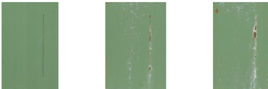
Obrázek 35: nalevo je vzorek s lamelárním zinkem + PANI-CAR při OKP 1 % s vrchním nátěrem před expozicí, uprostřed je vzorek ze střídání cyklů po 864 hodinové expozici a napravo je vzorek z neutrální solné mlhy po 864 hodinové expozici.
