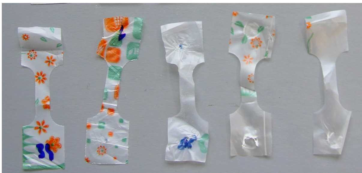
Obrázek 48 Optické srovnání fólií z Mater-Bi zleva: bez degradace, po 7 a 14 dnech na povětrnosti, po 7 a 24 hodinách v QUV-panelu
