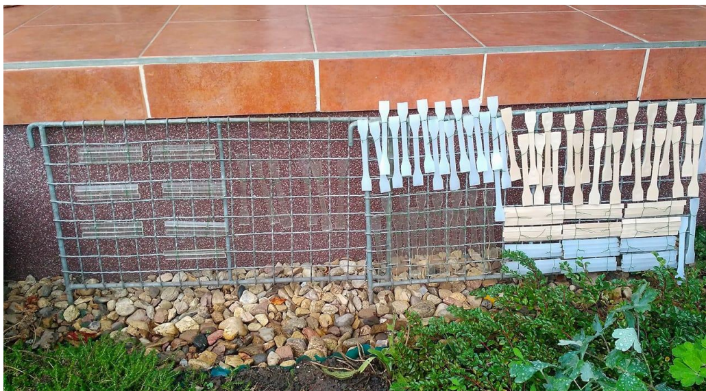
Obrázek 11 Systém uchycení vzorků pro degradaci na povětrnosti
