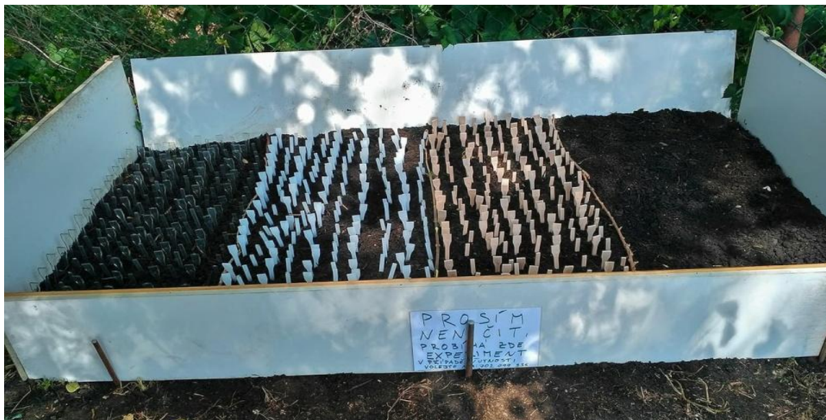
Obrázek 10 Kompostový záhon se zkušebními tělisky.
