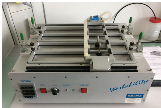
Obrázok 25 Prístroj pre stanovenie odolnosti voči oteru za mokra
