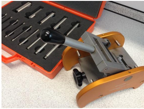
Obrázok 27 Prístroj na testovanie odolnosti voči ohybu s tŕňmi.
