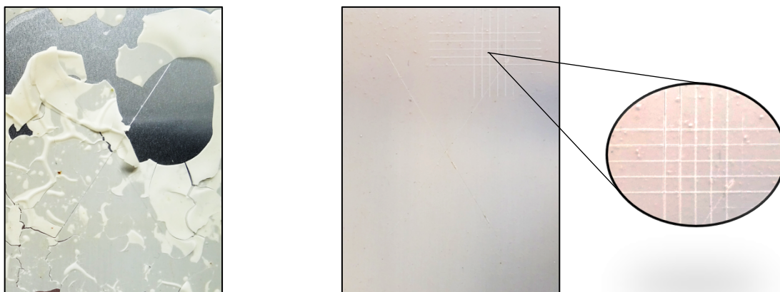
Obrázok 56 Vplyv nanočastíc ZnO na priľnavosť – spojivo HDS + CMP OKP 10% (vľavo) a LZn + CMP OKP 10 % (vpravo) po 3 cykloch, plnivo Plastorit, Q=košť.
