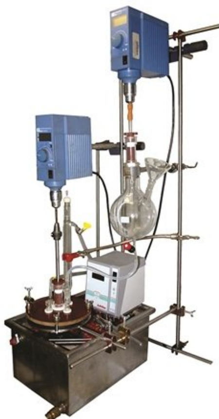
Obrázok 17 Aparatúra emulznej polymerizácie.
