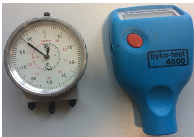
Obrázok 19 Mechanický (vľavo) a magnetický (vpravo) prístroj na meranie hrúbky náteru.
