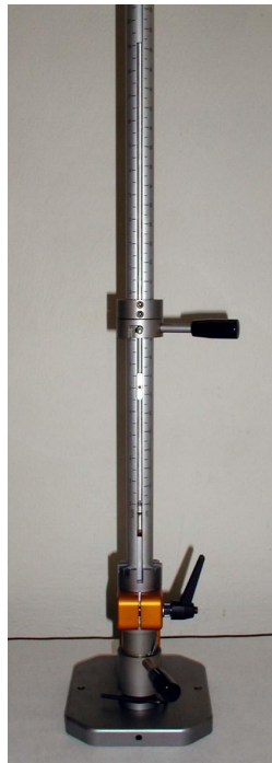
Obrázok 28 Prístroj na testovanie odolnosti náteru voči pádu závažia.
