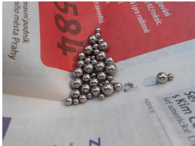
Obrázek 17 - Ocelové kuličky: náhražky skutečných kapek pro kalibraci
