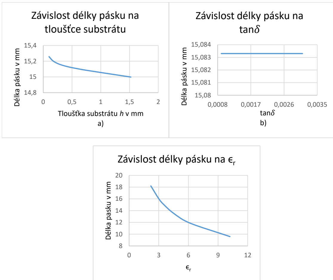
Obrázek 17 - Graf vlivu parametrů substrátu na délku pásku a) vliv tloušťky substrátu b) vliv \tan\delta c) vliv \epsilon_r na délku pásku
