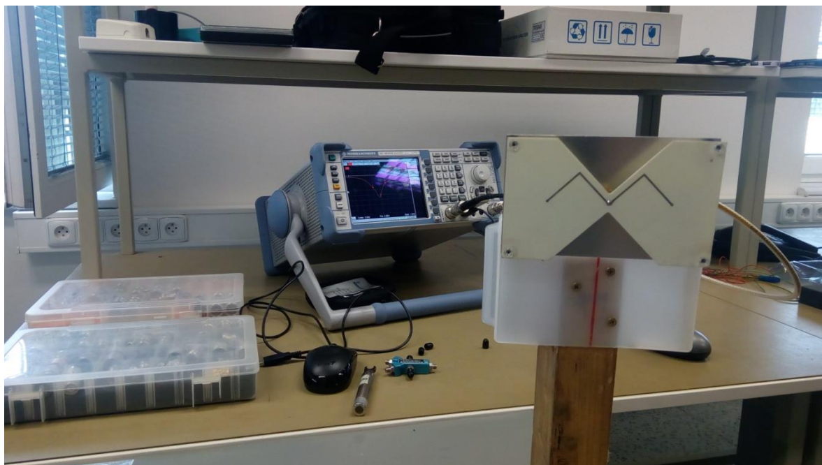
Obrázek 74 - Měření S11 parametru na prototypu antény pomocí vektorového analyzátoru
