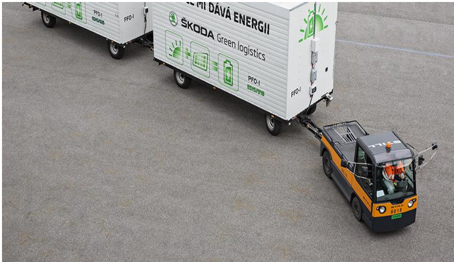
Obrázek 10 Elektrický tahač STILL a dva návěsy EDIS se solárními panely (ŠKODA AUTO a.s., 2016)
