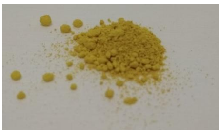
Obrázek 14 - Vzorek analyzovaného pigmentu s obsahem F 14 hm. %
