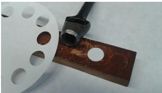
Obrázek 19 - Ilustrační obrázek raznice a přípravy jednotlivých nosičů
