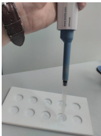
Obrázek 20 - Aplikace analyzovaného roztoku pomocí automatické pipety
