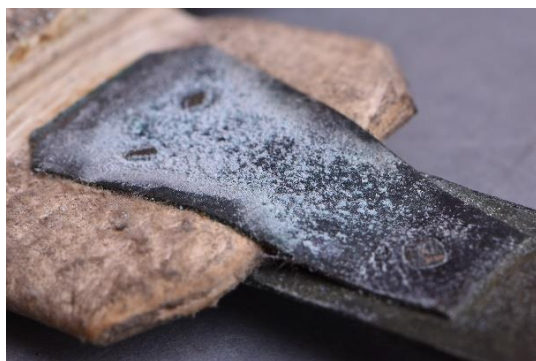
Obr. č. 72 Ďalšie príklady poškodenia koróziou spôsobenou chloridovými iónmi. Sign. XX B β 1, XIX A 5
