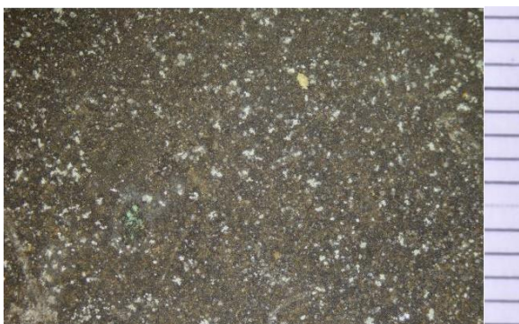
Obr. č. 83 Vzorka 10/3: Čistenie 8 % kyselinou sírovou
