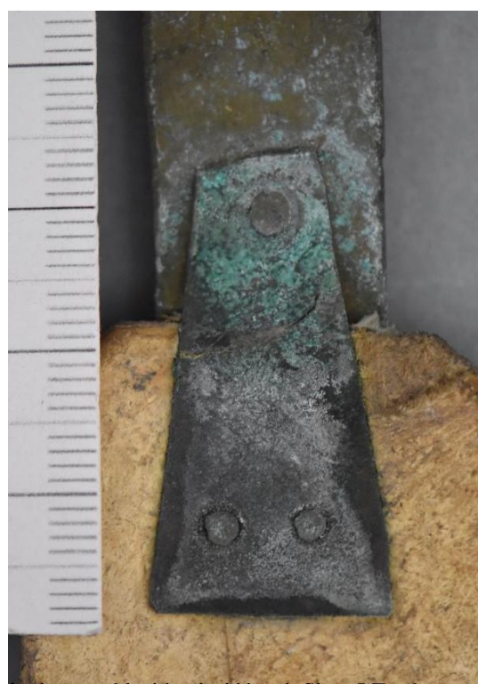
Obr. č. 71 Poškodenie spony koróziou spôsobenou chloridovými iónmi. Sign. I F α 9
