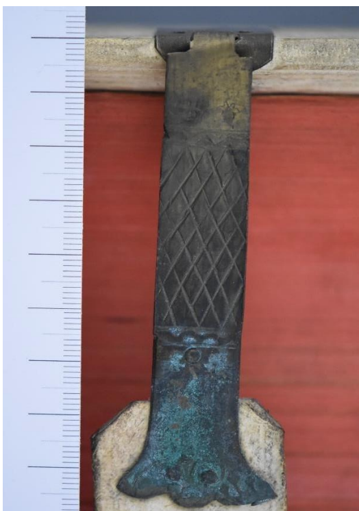
Obr. č. 71 Poškodenie spony koróziou spôsobenou chloridovými iónmi. Sign. I F α 9
