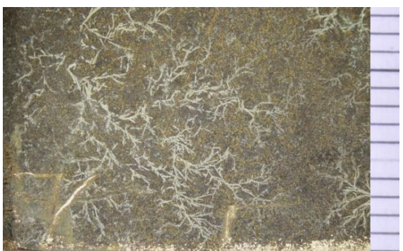
Obr. č. 75 Vzorka 2/3: Čistenie skleneným vláknom za mokra
