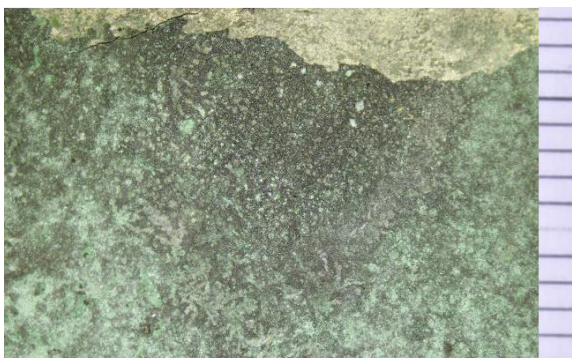
Obr. č. 76 Vzorka 3/1: Tryskanie orechovými škrupinkami
