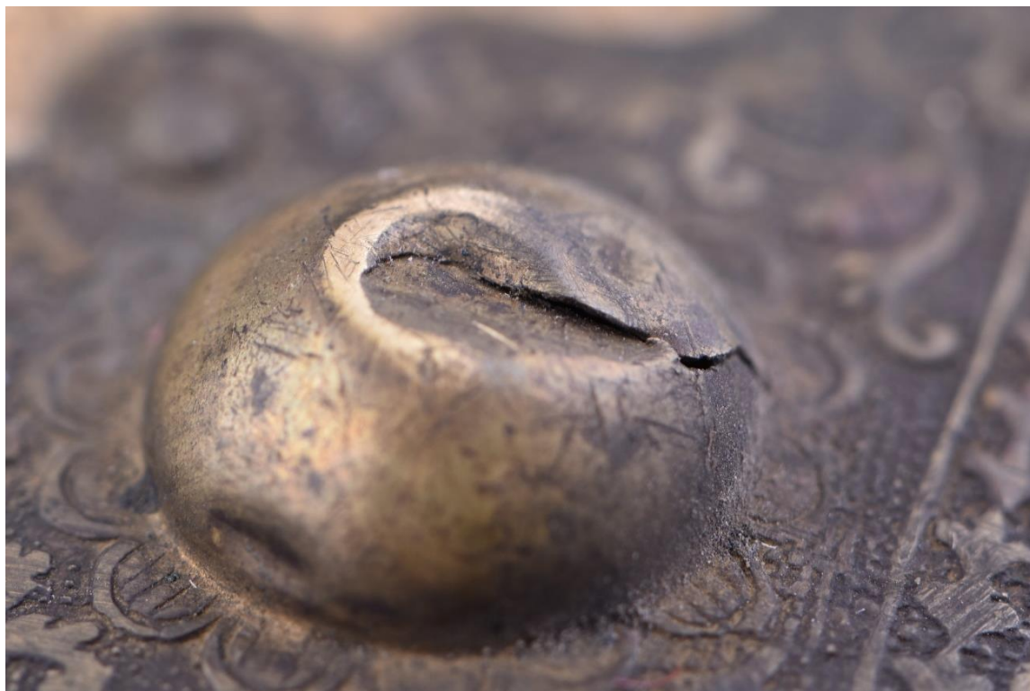
Obr. č. 64 Prasklina, ktorá bola zapríčinená predchádzajúcou deformáciou puklice. Sign. 1 F 1
