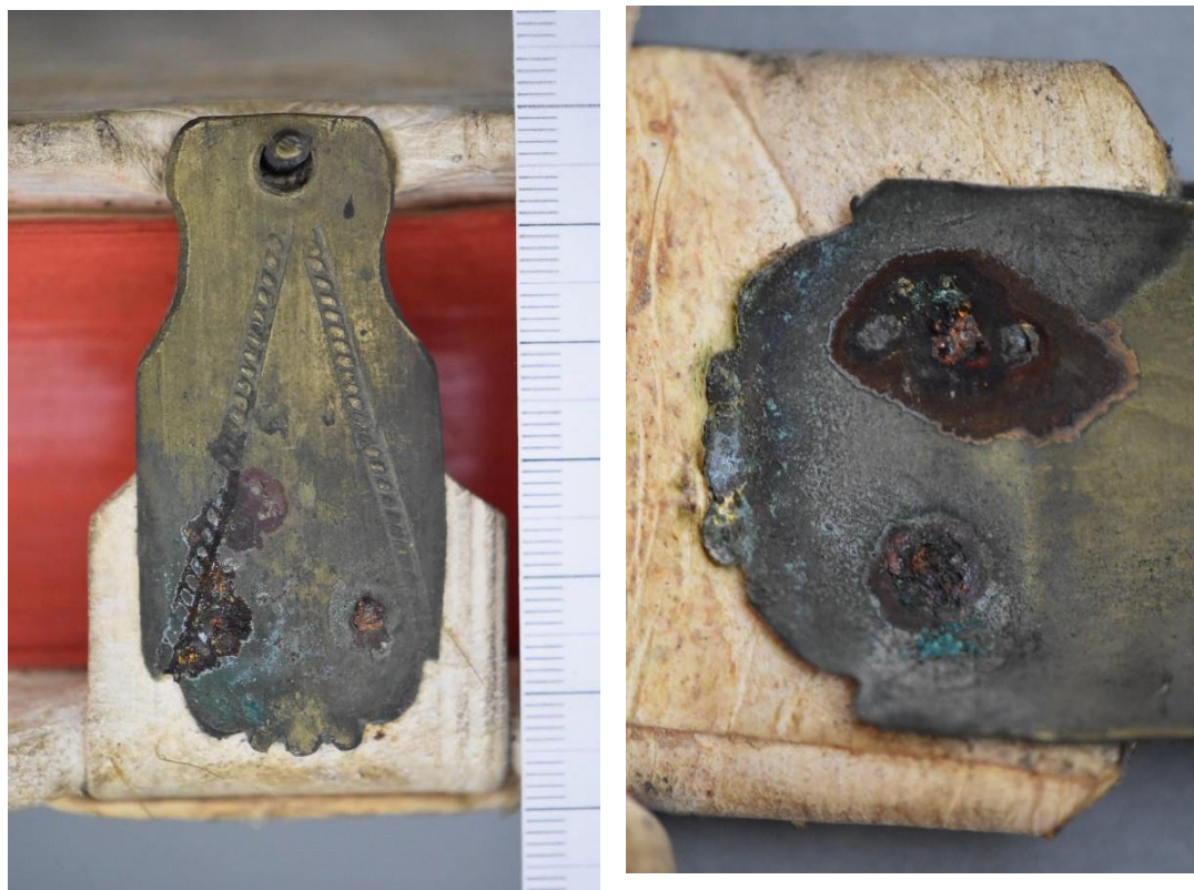
Obr. č. 69 vznik galvanického článku Sign I E \alpha 3
