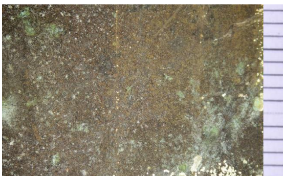
Obr. č. 80 Vzorka 8/4: Čistenie laserom
