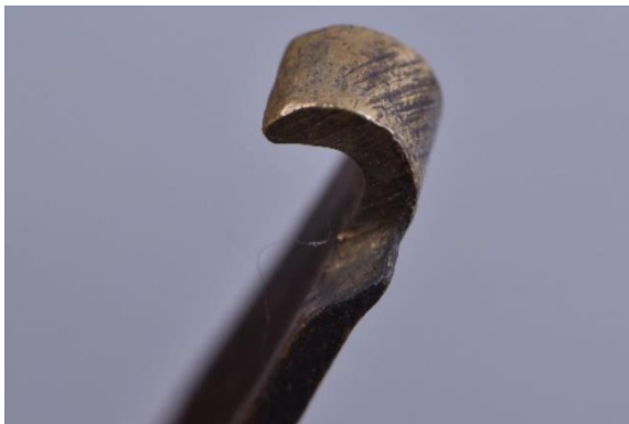
Obr.č. 32 Detail zhrenenie spony v oblasti háčika a na štítku spony. Sign. XXII A 8
