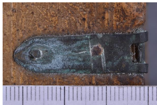
Obr. č. 72 Ďalšie príklady poškodenia koróziou spôsobenou chloridovými iónmi. Sign. XX B β 1, XIX A 5
