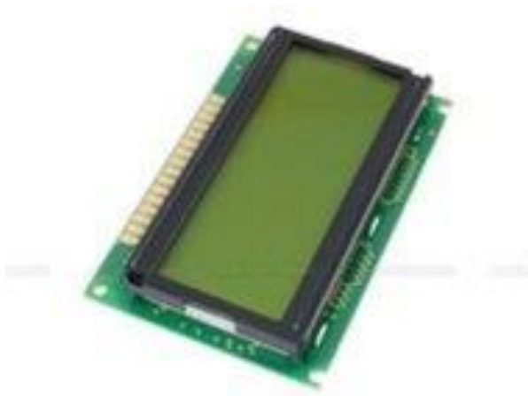
Obrázek 24. Alfanumerický displej MC1604C-SYL
