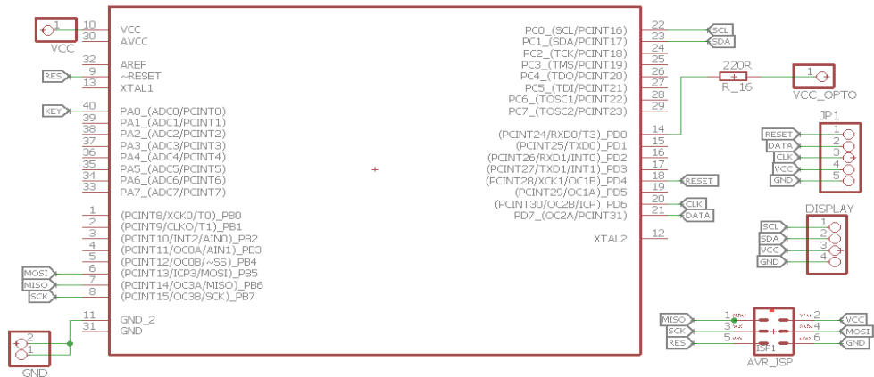
Obrázek 19. Schéma zapojení MCU a periferií
