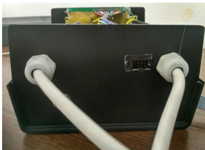
Obrázek č. 2 ISP konektor, pohled ze zadu
