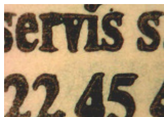
Obr. 34: Slití patek u serifového písma (velikost písma 4 body, zvětšení 200krát) [2]
