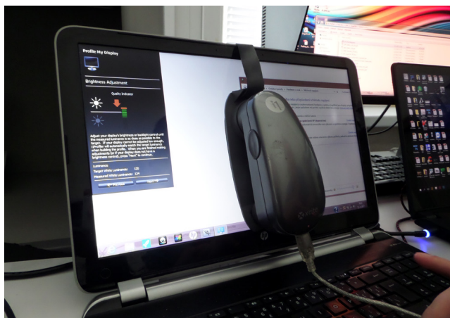
Obr. 22: Kalibrace zobrazovacího systému notebooku pomocí kalibrační sondy
