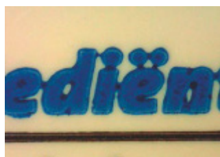
Obr. 33: Zalití znaků u tučného řezu písma (velikost písma 4 body, zvětšení 200krát) [2]
