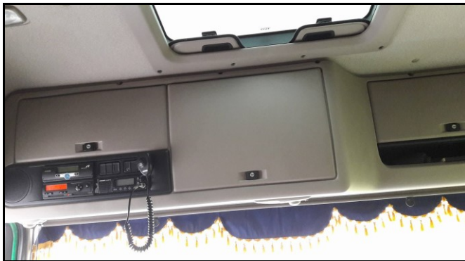
Obrázek 22 Úložné uzavíratelné skříňky nad čelním sklem (autorka)
