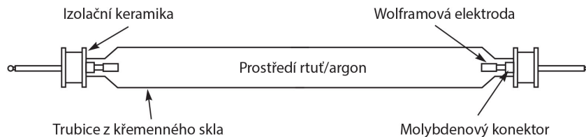
Obrázek 15 Schéma střednětlaké elektrodové rtuťové výbojky [5]
