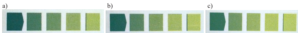
Obrázek 32 Fotocitlivé proužky CON-TROL-CURE® UV Fastcheck™ Strips po průjezdu tiskovým strojem při 100% výkonu výbojek a rychlosti tisku a) 4 000 archů/hod., b) 7 000 archů/hod., c) 10 000 archů/hod.
