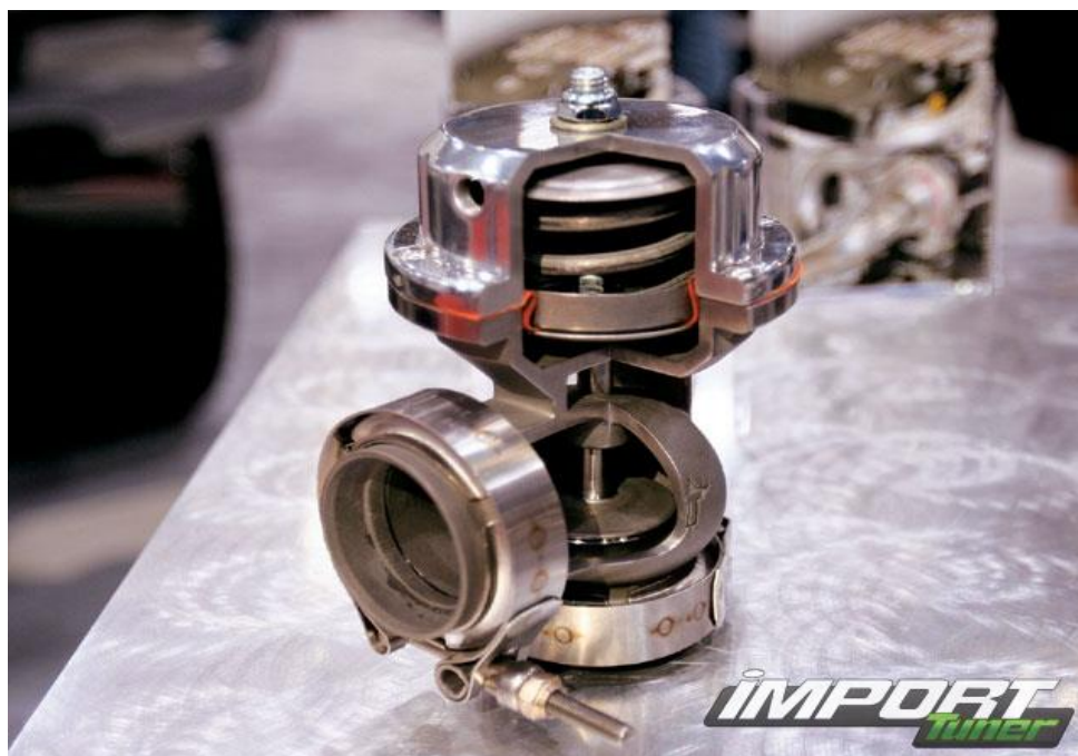
Obrázek 7 - Řez wastegate ventilem [37]
