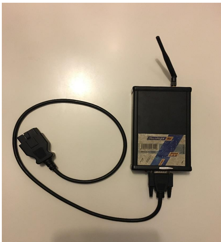
Obrázek 15 - SuperVAG diagnostika [autor]
