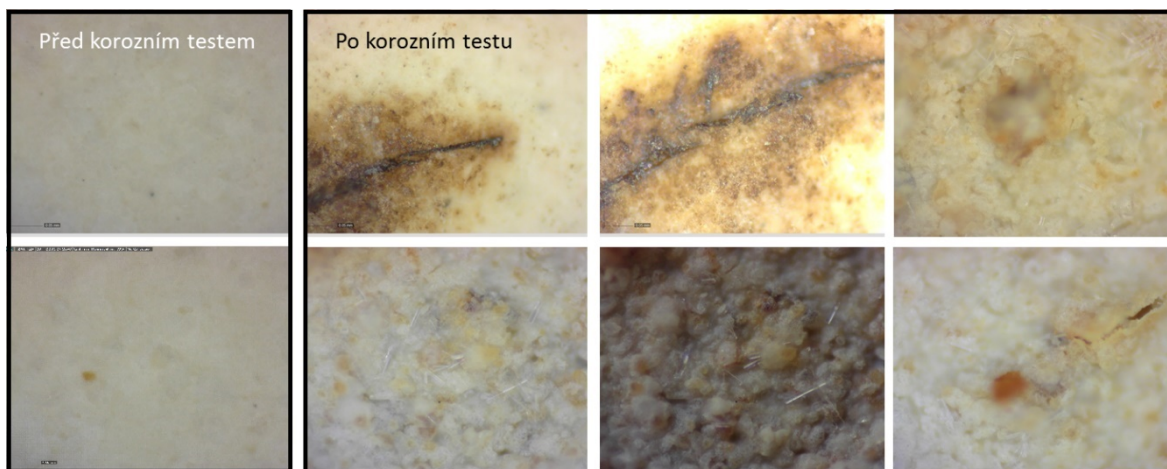
Obrázek 39: Vzorek 1 před i po proběhnutí korozního testu
