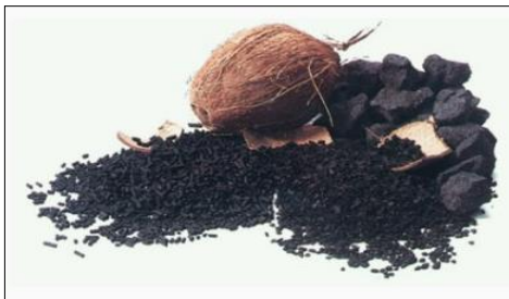
Obr. 2: Ukázka granulovaného aktivního uhlí vyrobeného z kokosového ořechu [29]
