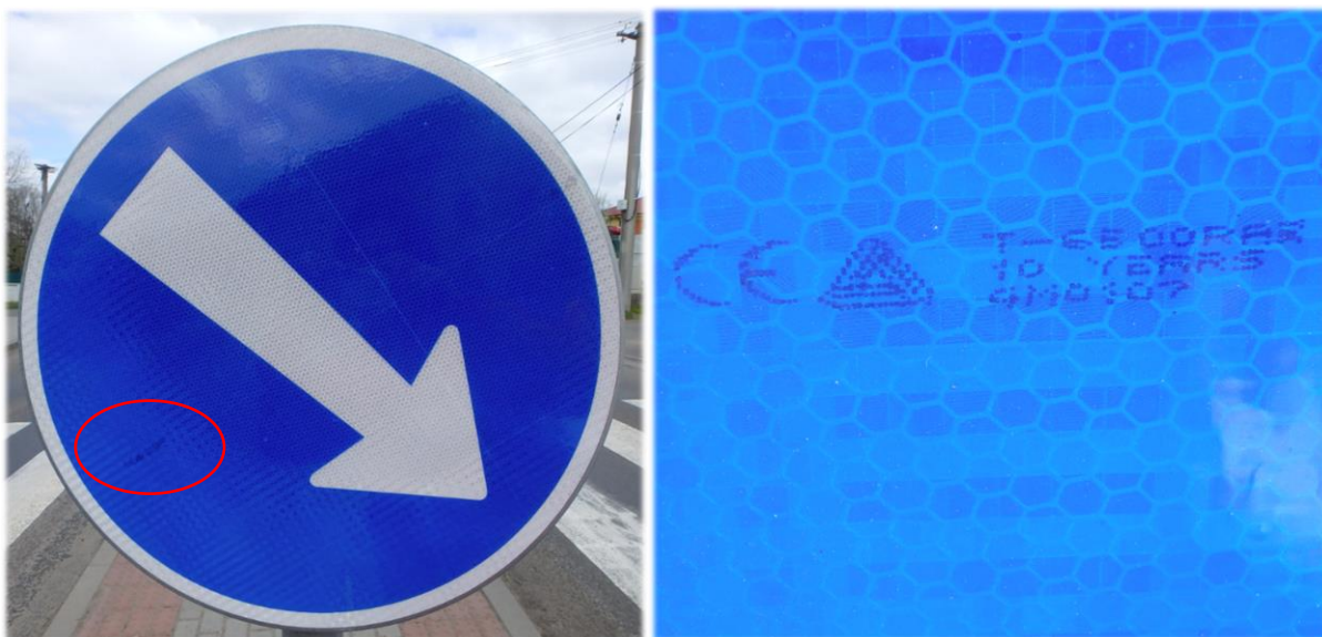
Obrázek 11, 12: Lícová plocha folie a detail označení druhu folie-zde T-6500 RA2, 10 Years, Zdroj: [Autor]
