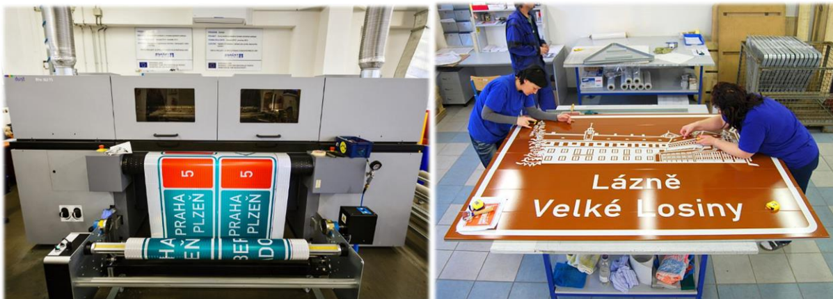
Obrázek 46, 47: Tisk reflexních dálničních ukazatelů na digitální tiskárně a aplikační dílna, Zdroj: [14], [15]
