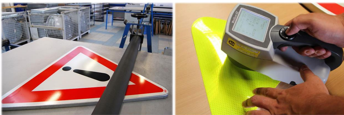
Obrázek 50, 51: Aplikace folie na plech značky a kontrola kolority folie spektrofotometrem, Zdroj: [15], [16]
