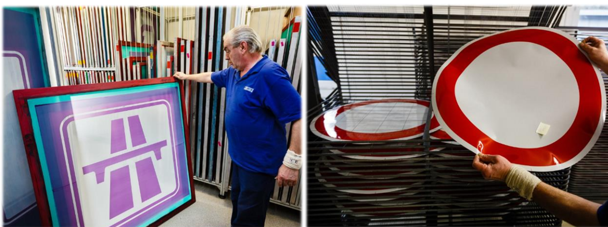
Obrázek 48, 49: Ukázka metody sítotisku - vlevo je vidět tisková šablona, vpravo hotové folie, Zdroj: [14]
