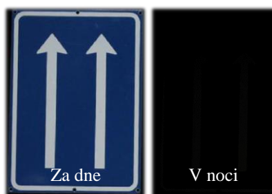
Obrázek 13, 14: Porovnání viditelnosti značky z neretroreflexní folie, Zdroj: [5]
