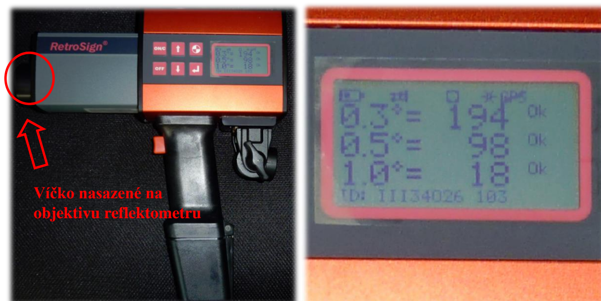
Obrázek 57, 58: Kontrola kalibrace přístroje, Zdroj: [Autor]
