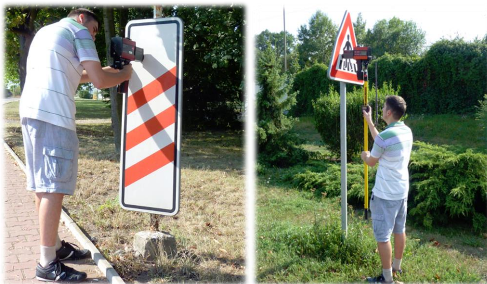
Obrázek 59, 60: Způsoby měření retroreflexe, Zdroj: [Autor]
