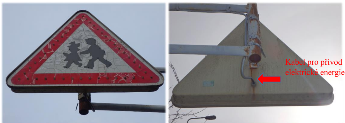
Obrázek 15, 16: Prosvětlovaná dopravní značka zvýrazněná LED diodami, Zdroj: [Autor]
