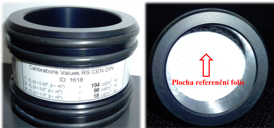
Obrázek 55, 56: Kalibrační víčko s hodnotami retroreflexe a referenční folie na vnitřní straně víčka, Zdroj: [Autor]
