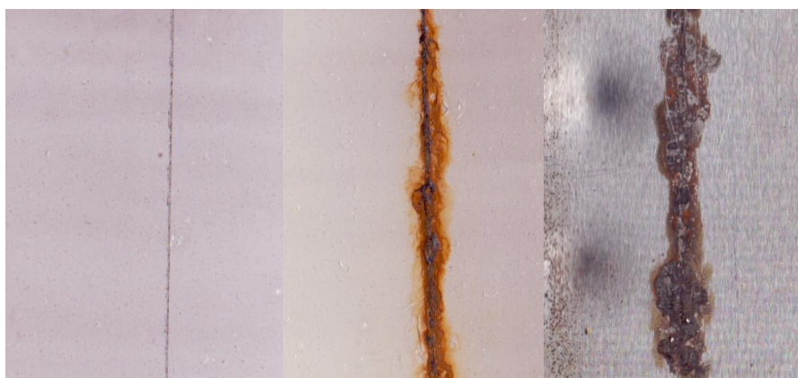
Příloha 95: Zinkferit (H) při OKP 20 % po cyklické zkoušce, 1) před vložením, 2) po 30 cyklech, 3) po odstranění nátěru
