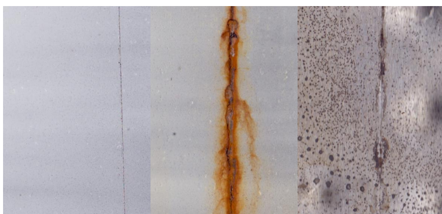
Příloha 80: Worlée Dur46 po cyklické zkoušce, 1) před vložením, 2) po 30 cyklech, 3) po odstranění nátěru
