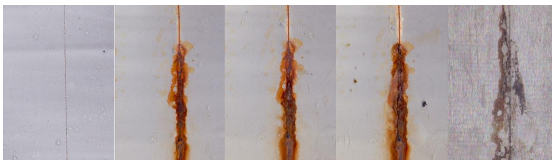
Příloha 53: Zinkferit (S) při OKP 10 % v atmosféře NaCl, 1) před vložením, 2) po 600 hodinách, 3) po 1080 hodinách, 4) po 1344 hodinách, 5) po odstranění nátěru
