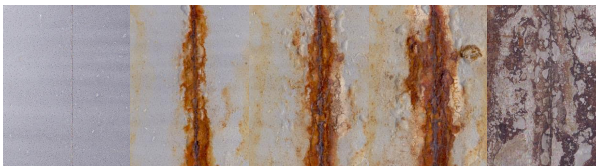
Příloha 59: Zinkferit (S) / PPDA při OKP 25 % v atmosféře NaCl, 1) před vložením, 2) po 600 hodinách, 3) po 1080 hodinách, 4) po 1344 hodinách, 5) po odstranění nátěru
