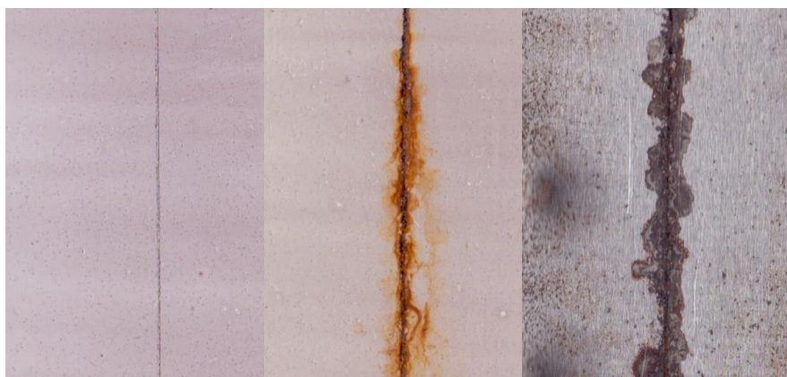
Příloha 100: Zinkferit (H) / PPDA při OKP 25 % po cyklické zkoušce, 1) před vložením, 2) po 30 cyklech, 3) po odstranění nátěru
