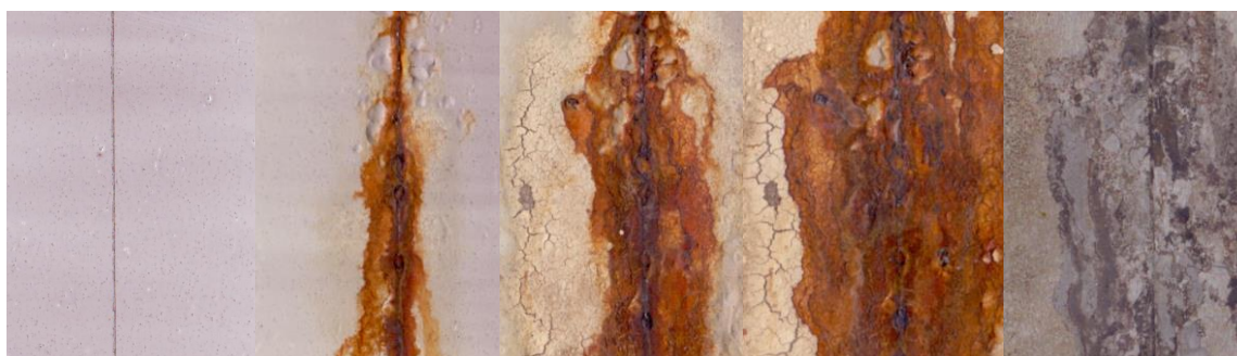
Příloha 69: Zinkferit (H) / PPDA při OKP 10 % v atmosféře NaCl, 1) před vložením, 2) po 600 hodinách, 3) po 1080 hodinách, 4) po 1344 hodinách, 5) po odstranění nátěru
