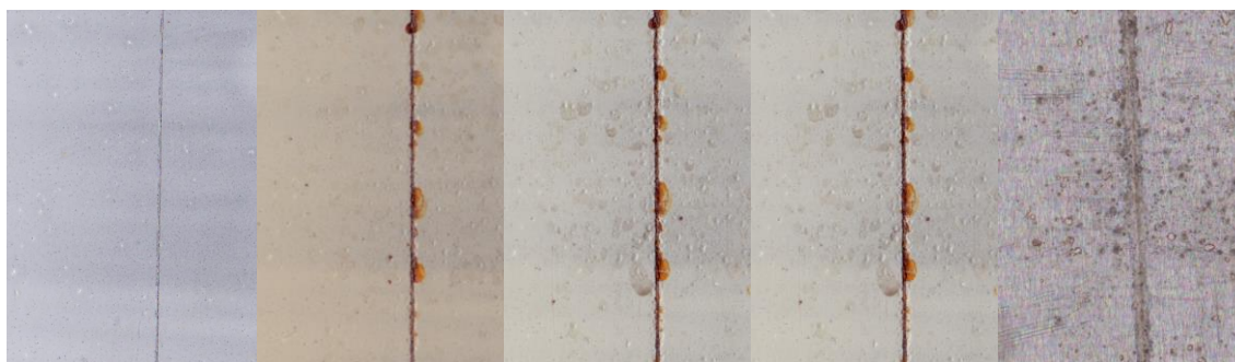
Příloha 35: Zinkferit (H) při OKP 5 % v atmosféře SO 2 , 1) před vložením, 2) po 552 hodinách, 3) po 864 hodinách, 4) po 1008 hodinách, 5) po odstranění nátěru
