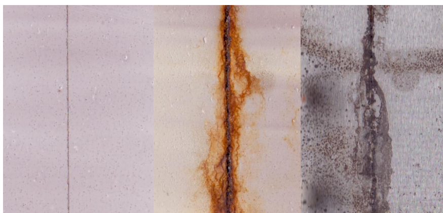
Příloha 98: Zinkferit (H) / PPDA při OKP 10 % po cyklické zkoušce, 1) před vložením, 2) po 30 cyklech, 3) po odstranění nátěru
