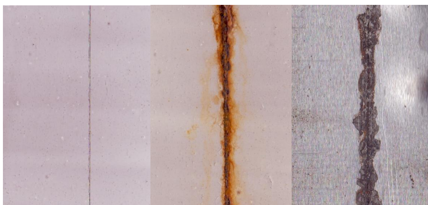
Příloha 101: Zinkferit (H) / PANI při OKP 5 % po cyklické zkoušce, 1) před vložením, 2) po 30 cyklech, 3) po odstranění nátěru
