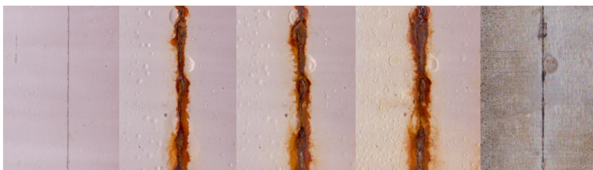
Příloha 65: Zinkferit (H) při OKP 10 % v atmosféře NaCl, 1) před vložením, 2) po 600 hodinách, 3) po 1080 hodinách, 4) po 1344 hodinách, 5) po odstranění nátěru
