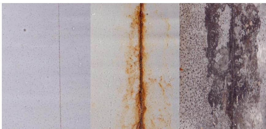
Příloha 98: Zinkferit (H) / PPDA při OKP 10 % po cyklické zkoušce, 1) před vložením, 2) po 30 cyklech, 3) po odstranění nátěru
