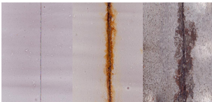
Příloha 104: Zinkferit (H) / PANI při OKP 25 % po cyklické zkoušce, 1) před vložením, 2) po 30 cyklech, 3) po odstranění nátěru
