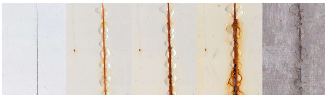
Příloha 49: Plastroit Super v atmosféře NaCl, 1) před vložením, 2) po 600 hodinách, 3) po 1080 hodinách, 4) po 1344 hodinách, 5) po odstranění nátěru
