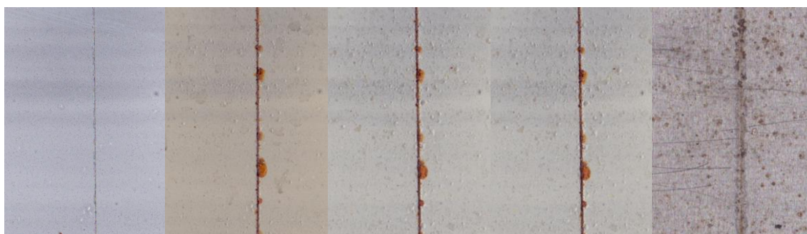
Příloha 33: Zinkferit (S) / PANI při OKP 20 % v atmosféře SO 2 , 1) před vložením, 2) po 552 hodinách, 3) po 864 hodinách, 4) po 1008 hodinách, 5) po odstranění nátěru
