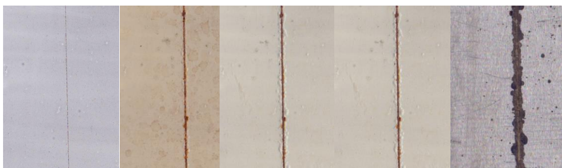
Příloha 24: Zinkferit (S) při OKP 10 % v atmosféře SO 2 , 1) před vložením, 2) po 552 hodinách, 3) po 864 hodinách, 4) po 1008 hodinách, 5) po odstranění nátěru
