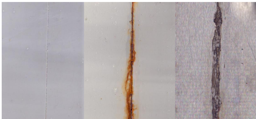
Příloha 79: Spekularit s Plastoritem Super při OKP 10% po cyklické zkoušce, 1) před vložením, 2) po 30 cyklech, 3) po odstranění nátěru
