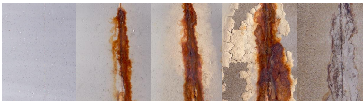
Příloha 57: Zinkferit (S) / PPDA při OKP 10 % v atmosféře NaCl, 1) před vložením, 2) po 600 hodinách, 3) po 1080 hodinách, 4) po 1344 hodinách, 5) po odstranění nátěru
