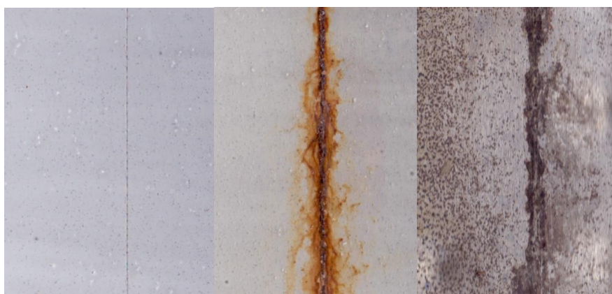
Příloha 86: Zinkferit (S) / PPDA při OKP 10 % po cyklické zkoušce, 1) před vložením, 2) po 30 cyklech, 3) po odstranění nátěru
