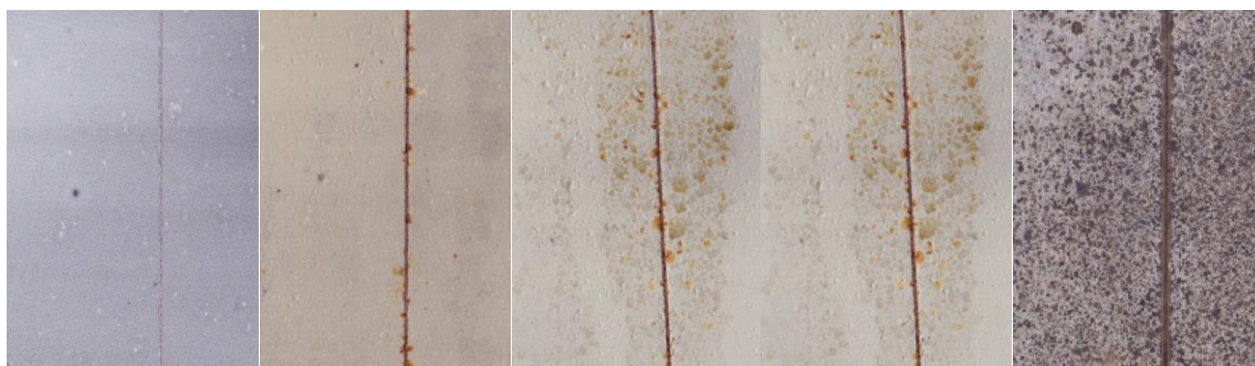
Příloha 27: Zinkferit (S) / PPDA při OKP 5 % v atmosféře SO 2 , 1) před vložením, 2) po 552 hodinách, 3) po 864 hodinách, 4) po 1008 hodinách, 5) po odstranění nátěru
