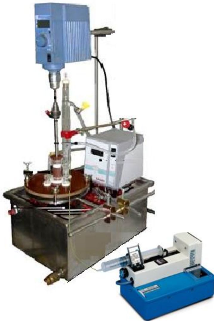
Obr. 16: Aparatura pro polymeraci latexů s automatickým dávkovačem
