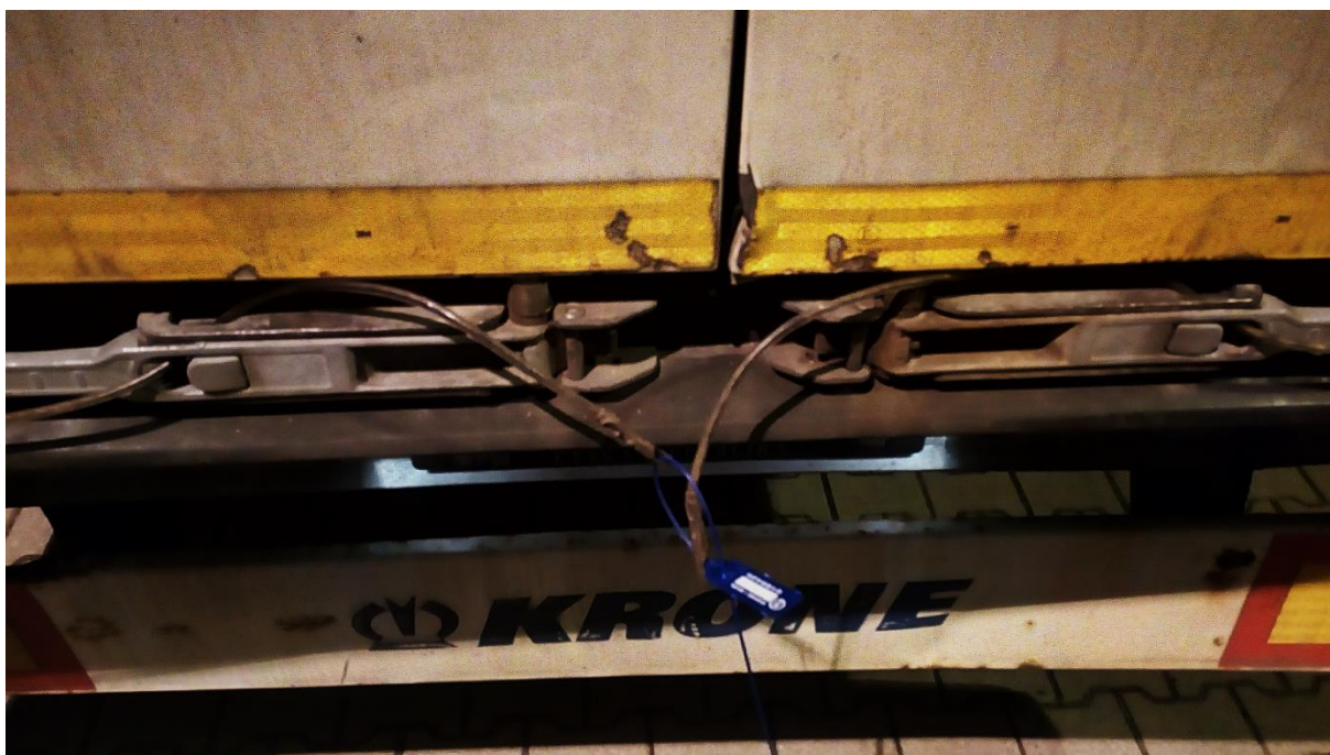
Obrázek 19 Spojení celního lanka plombou
