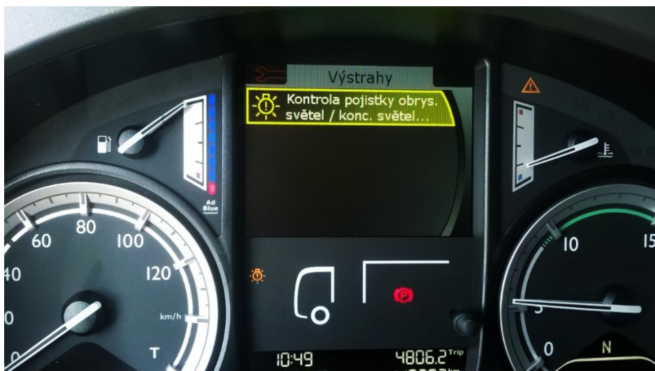
Obrázek 21 Hlášení závady pojistky
