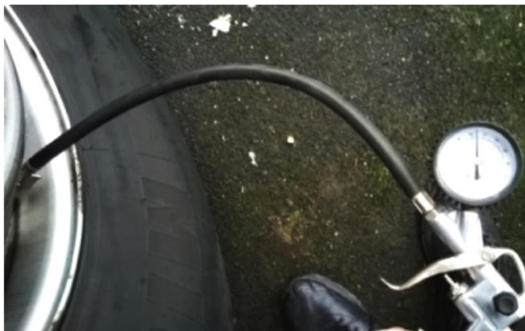
Obrázek 23 Kontrola nahuštění pneumatiky pomocí tlakoměru
