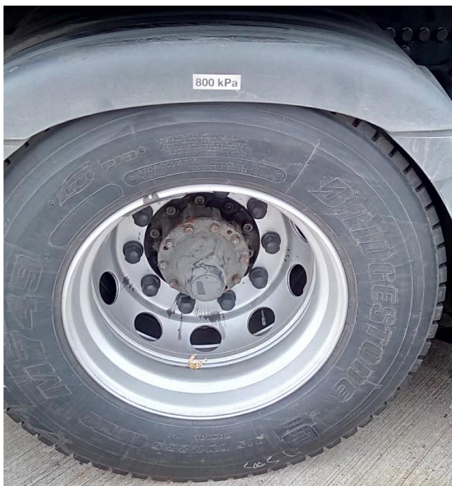
Obrázek 25 Předepsaný tlak přímo nad nápravou
