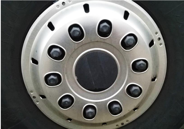
Obrázek 22 Upevnění kola kolovými maticemi s krytkami
