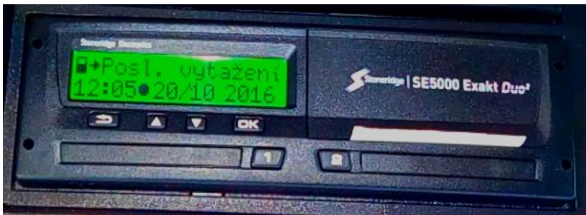
Obrázek 5 Načtení karty řidiče
