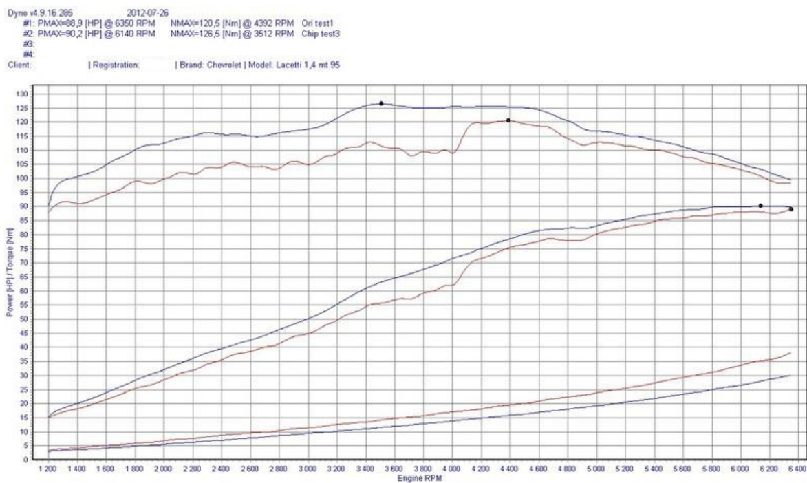
Obrázek 23. Změna výkonu a točivého momentu v závislosti na otáčkách vozidla před a po úpravě dat řídicí jednotky vozidla Chevrolet Lacetti 1.4 (25)
