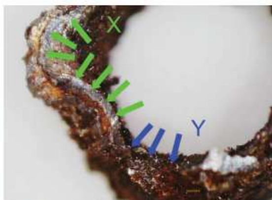
Obr. 10. Korozní poškození brzdové trubky: X = lomová plocha čerstvého lomu; Y = hloubka průniku koroze stěnou brzdové trubky
