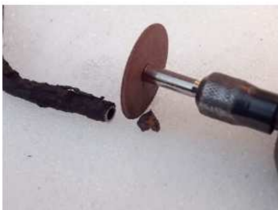
Obr. 8. Odběr vzorků z poškozeného potrubí Fig. 8. Sampling of pipes damaged by corrosion
