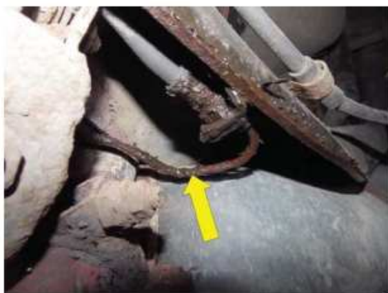
Obr. 4. Únik brzdové kapaliny z korozně poškozené brzdové trubky Fig. 4. Brake fluid leaking out of a brake pipe damaged by corrosion
