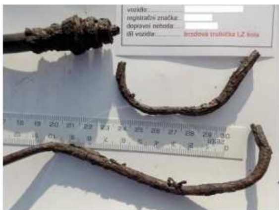
Obr. 5. Korozní poškození brzdového potrubí - celkový pohled Fig. 5. Brake pipes damaged by corrosion – overall view
