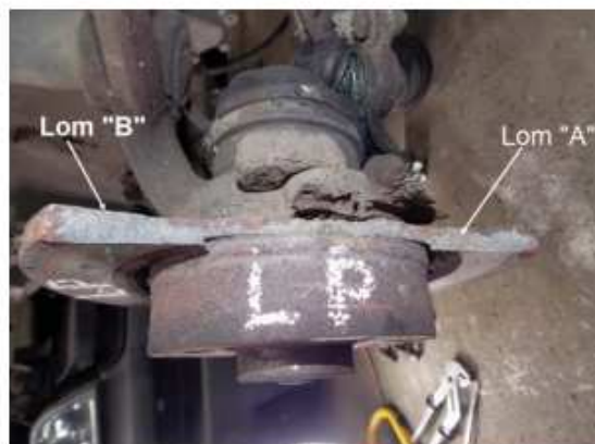
Obr. 3. Dvě barevně velmi mírně odlišné plochy lomu brzdového kotouče Fig. 3. Two refractive surfaces of a brake disc slightly different in color
