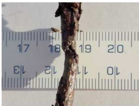
Obr. 6. Korozní poškození brzdového potrubí - detailní pohled Fig. 6. Brake pipes damaged by corrosion – detailed view
