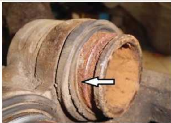
Obr. 2. Korozní poškození dílů brzd Fig. 2. Corrosion damage of the brake parts
