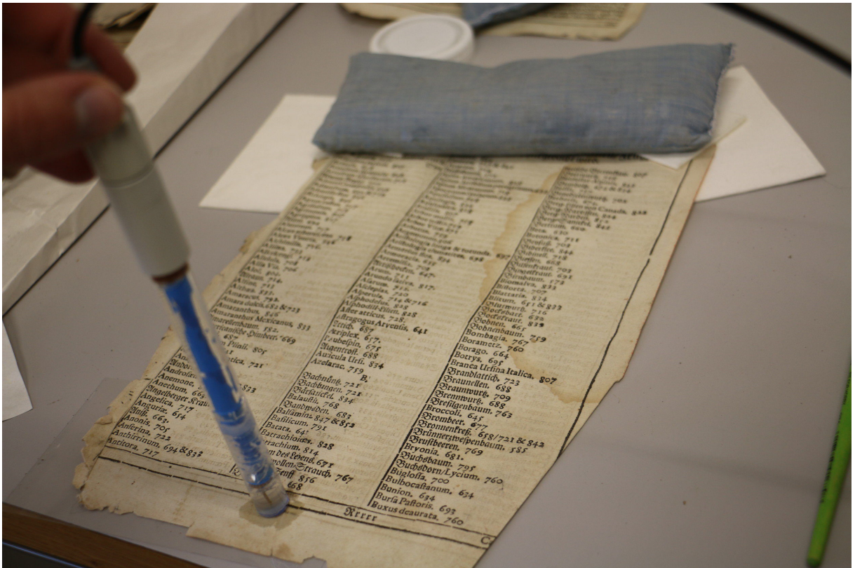
Obrázek A.2.5: Měření pH papírové podložky.
