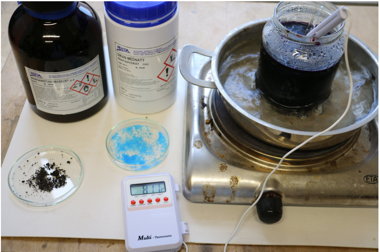
Obrázek A.2.29: Výroba patinačního roztoku na hřebíky.
