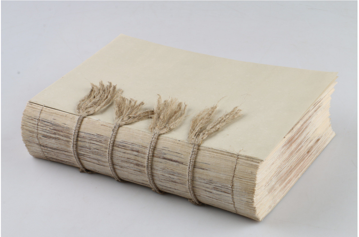
Obrázek A.2.39: Knižní blok po sešití a zkulacení hřbetu.
