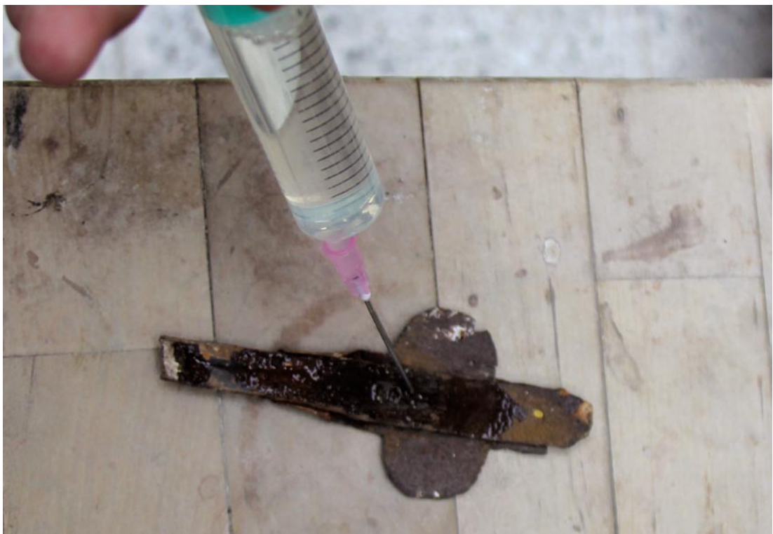
Obr. 23 - Ošetření křížku přípravkem Ferogard
