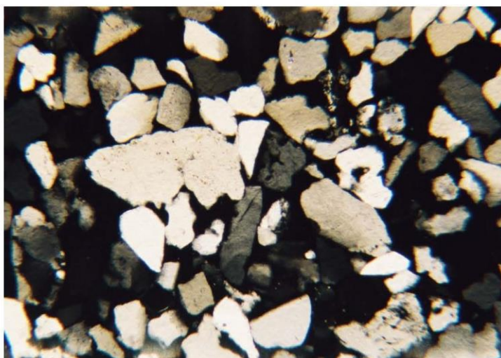
Pískovec křemenný, jemnozrný se střednězrnou příměsí, slabě silicifikovaný vzorek PNK-2, figury, zvětšení 32x, nikoly X jemnoz. křemenné úlomky s různým opracováním povrchu, fragment oválného klastu křemene
