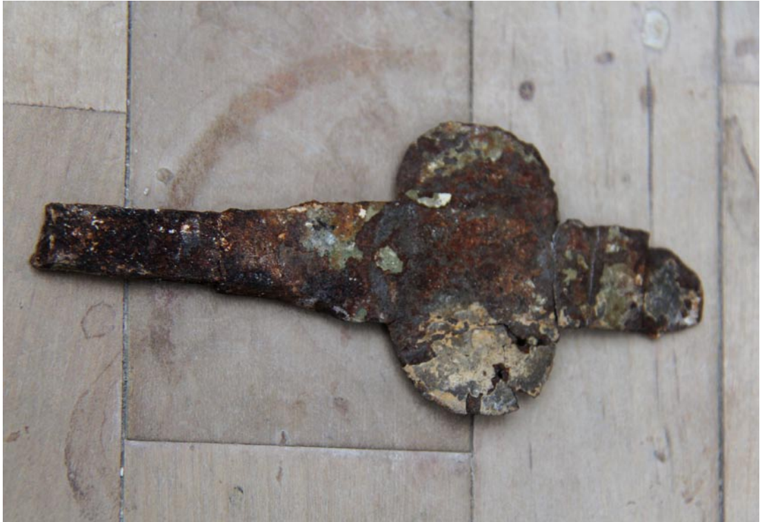
Obr. 22 - Křížek po vyjmutí z koruny a narovnání
