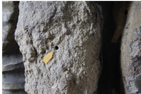
Obr. 6 - Odběr vzorku pro stanovení obsahu vodorozpustných solí
