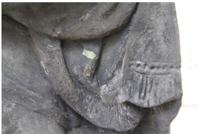
Obr. 11 - Odběr vzorku pro optickou mikroskopii krusty
