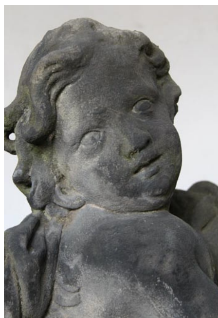
Obr. 2 - Černé silikátové krusty - na velké části povrchu sochy
