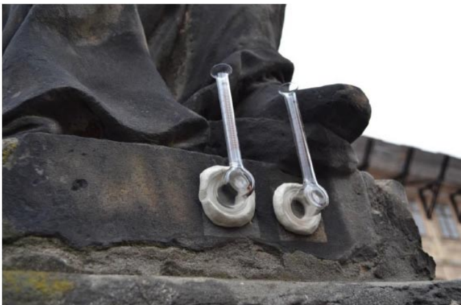
Obr. 9 - Měření nasákavosti foto. Lukáš Brotánek
