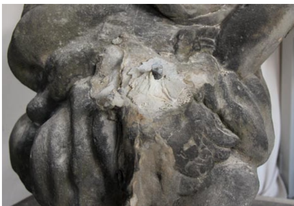
Obr. 5 - Místo oddělení hlavičky druhého andílka s čepem a svislá prasklina mezi tělem andílka a obláčkem
