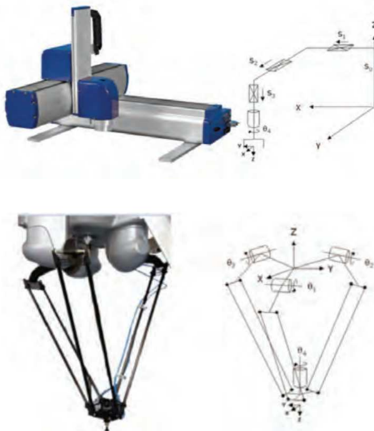
Obr. 1.3 – Otevřený a uzavřený řetězec (Švéda, 2009)
