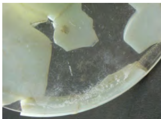
Obr. 4 Snímek dokumentující stav PMMA opory, zřejmě jsou škrábance a bílé mapy.
