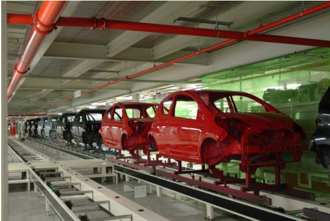
Obrázek 26: Speciální dopravník na linku Trim [26]
