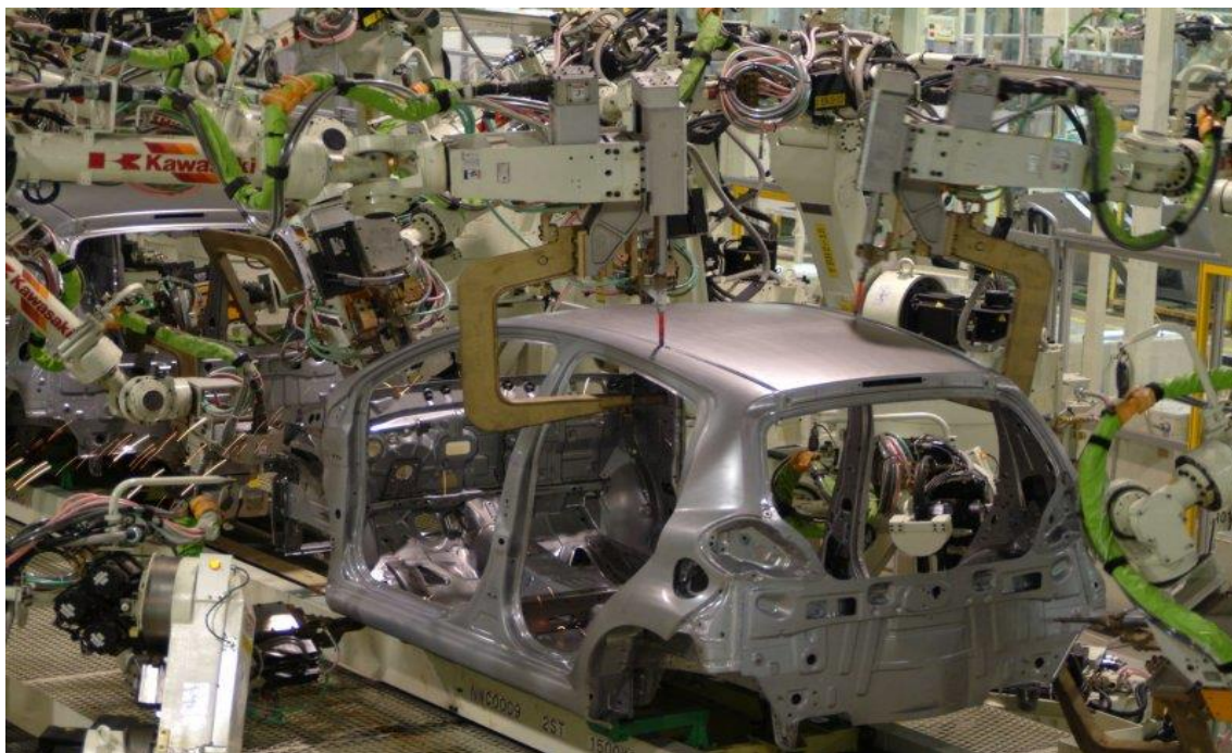
Obrázek 15: Fáze výroby – svařovna [24]
