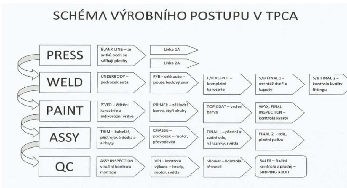
Obrázek 13: Schéma výrobního postupu v TPCA [interní dokument]
