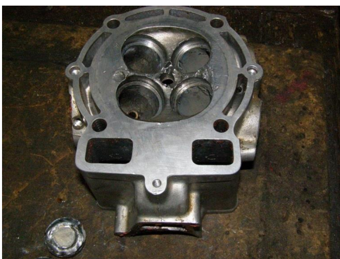
Obrázek 36 Demontovaná sedla ventilu
