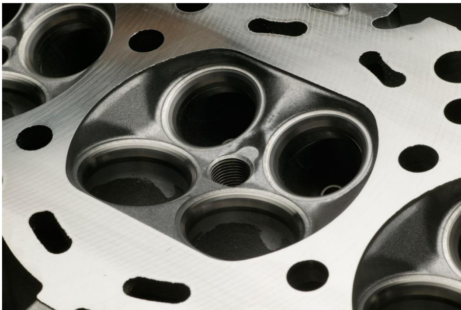
Obrázek 2 Střechovitý spalovací prostor s centrální polohou svíčky [5]
