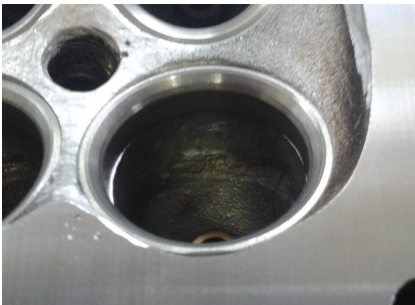
Obrázek 47 Opracované sedlo s dosedací plochou 45^\circ a korekčními úhly 15^\circ a 60^\circ
