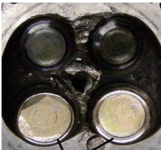
Vzniklá plocha poslouží pro provedení svaru
