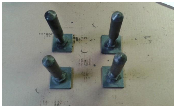
Obrázek 29 Stavěcí stojany pro ustavení hlavy do horizontální polohy
