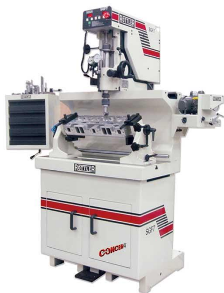
Obrázek 40 Stroj pro opravu sedel - Rottler SG7 [13]
