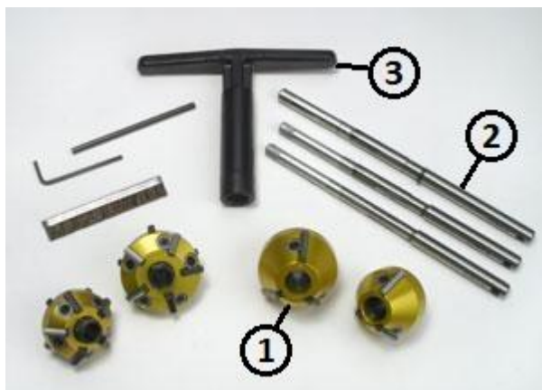
Obrázek 18 Sada pro opracování sedel ventilů: 1 – fréza, 2 – vodící trny 3 – vratidlo [14]
