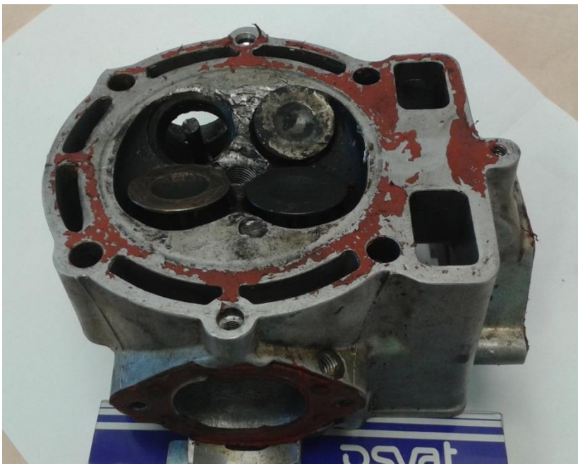
Obrázek 30 Demontovaná hlava motoru – výchozí stav
