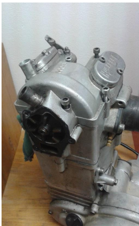
Obrázek 51 Usazené ventilové víko
