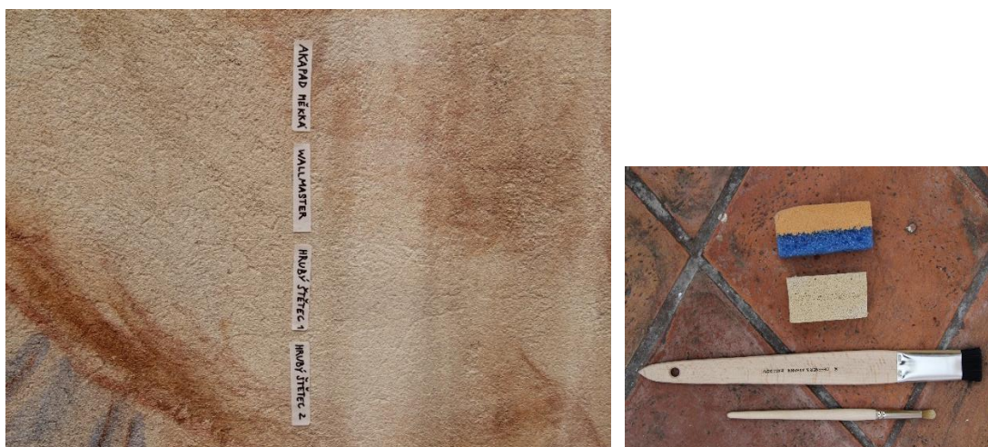
Obr. 5 a 6. Zkoušky čištění bílých hlinkových stěkanců. Nejlepšího výsledku bylo dosaženo latexovou houbičkou Akapad suchou cestou.
