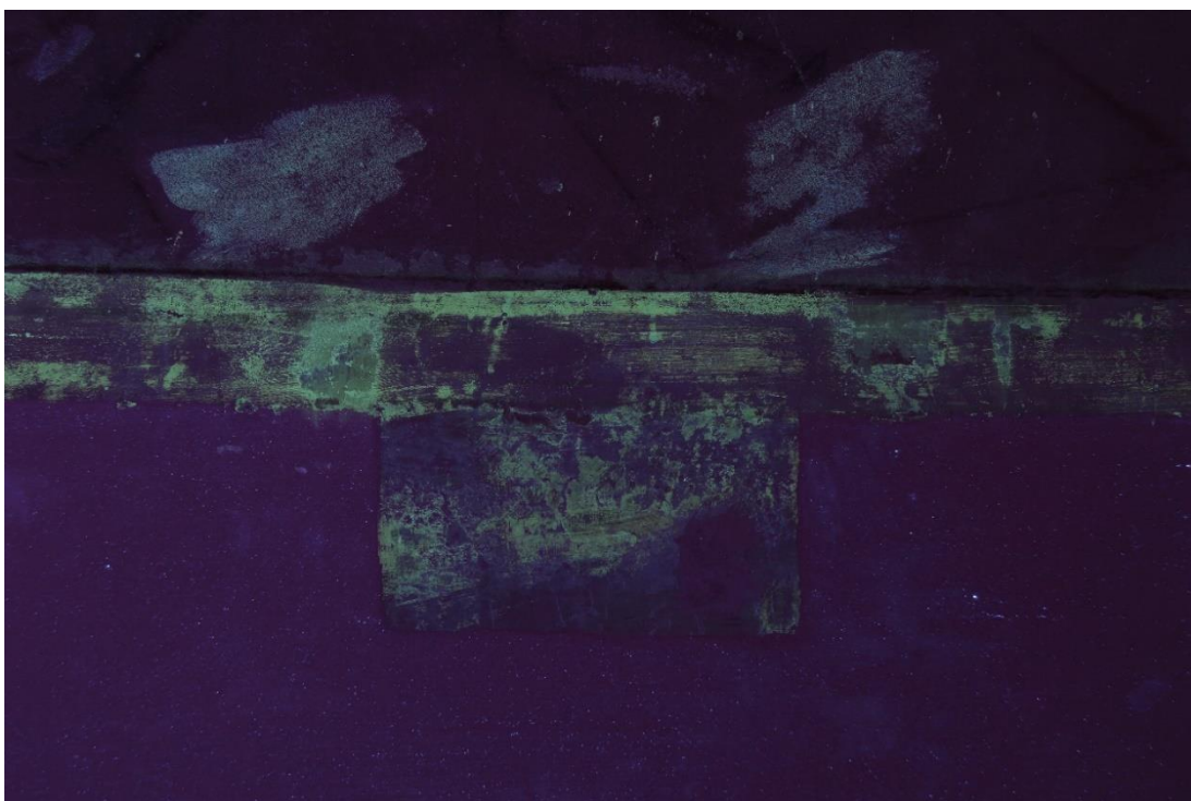
Obr. 40. Žlutozelená luminiscence poukazuje na použití zinkové běloby v okrovém nátěru, který se nacházel na celé soklové části.
