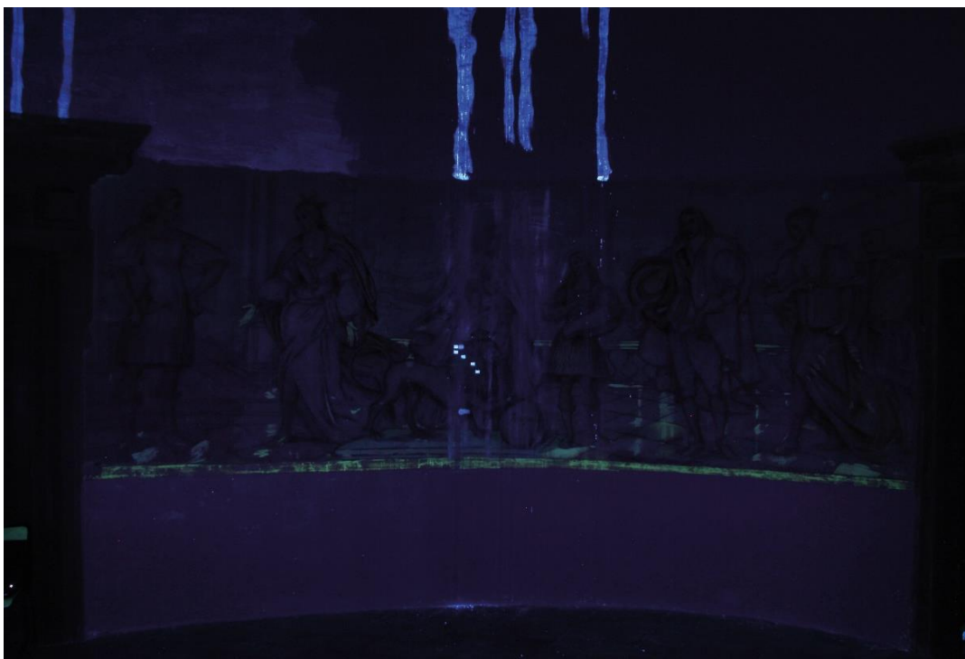
Obr. 35. Pohled na JZ stěnu v UV osvětlení. Výraznou žluto-zelenou luminiscenci vykazuje horní pás soklové části a některé detaily v malbě. Tato luminiscence poukazuje na použití zinkové běloby. Bílé stékance luminují velmi slabě. Uprostřed malby luminují bílé popisné štítky z roku 2013. (Zdroj: Vojtěchovský Jan, Ferdus Anna, Glombová Barbora, Slouková Lenka: Restaurátorský průzkum nástěnných maleb v hlavním sálu (tzv. akustickém) na zámku Humprecht. 2013. Dokumentace je uložena v archivu Fakulty restaurování Univerzity Pardubice. )
