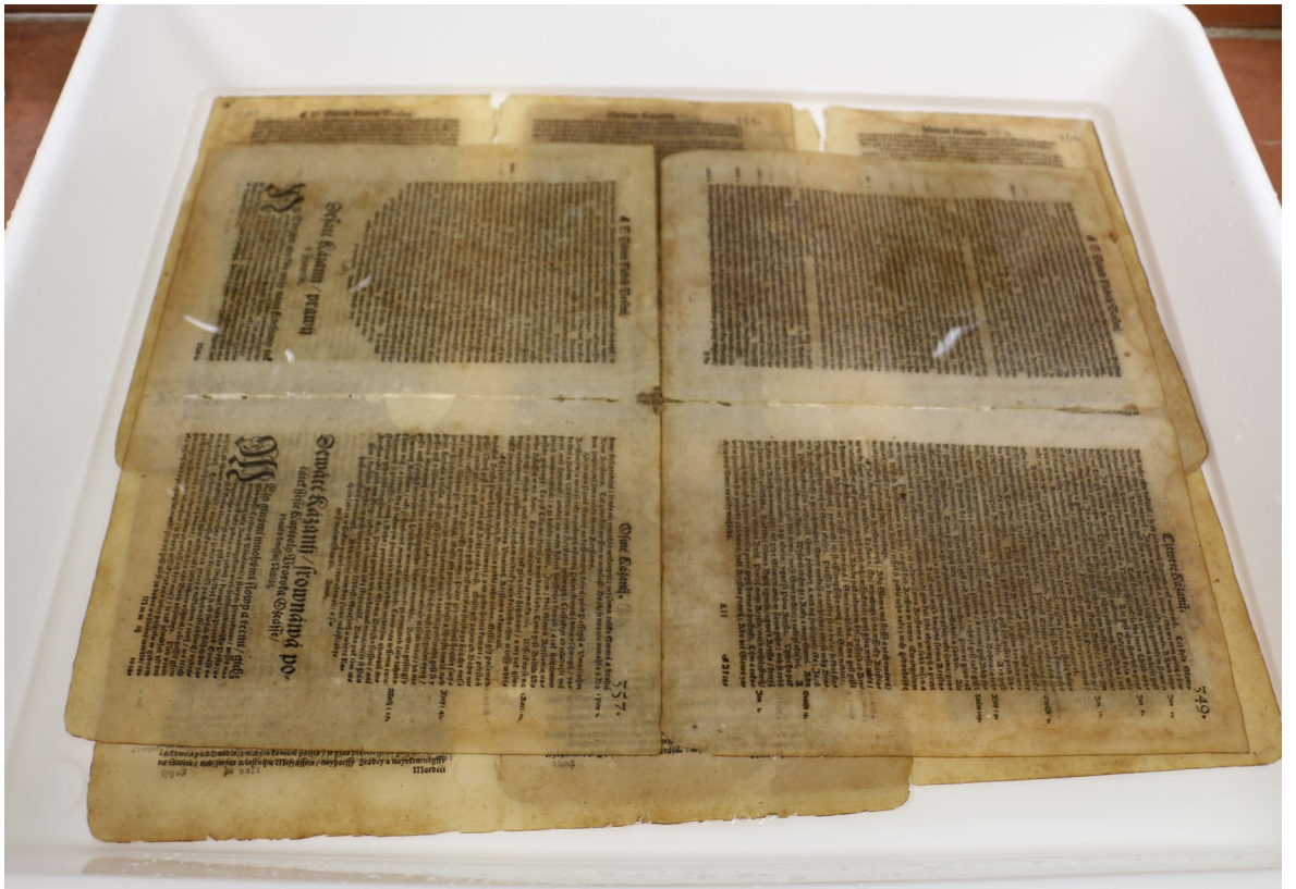
fotografia č. 43 – Mokrě čistenie vo vodnom kúpeli
