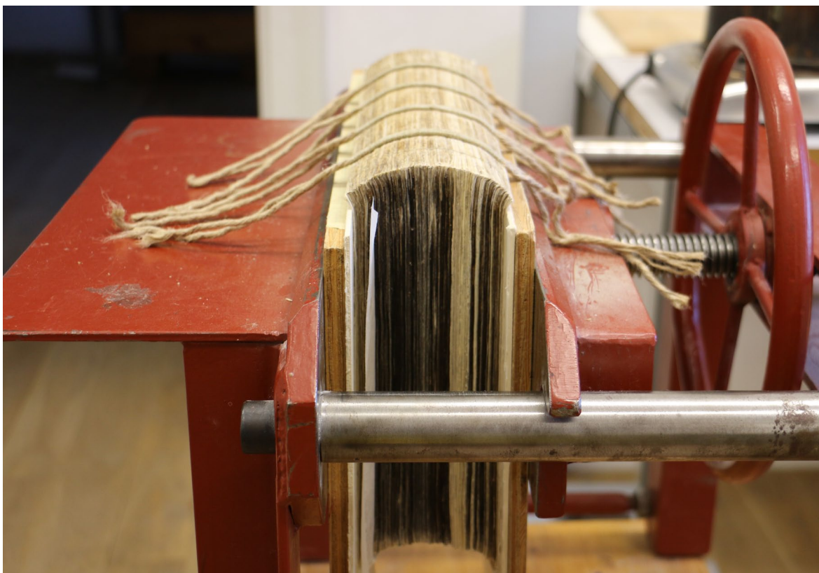
fotografia č. 51 – Zaguľatený blok schne v oklepávacom lise
