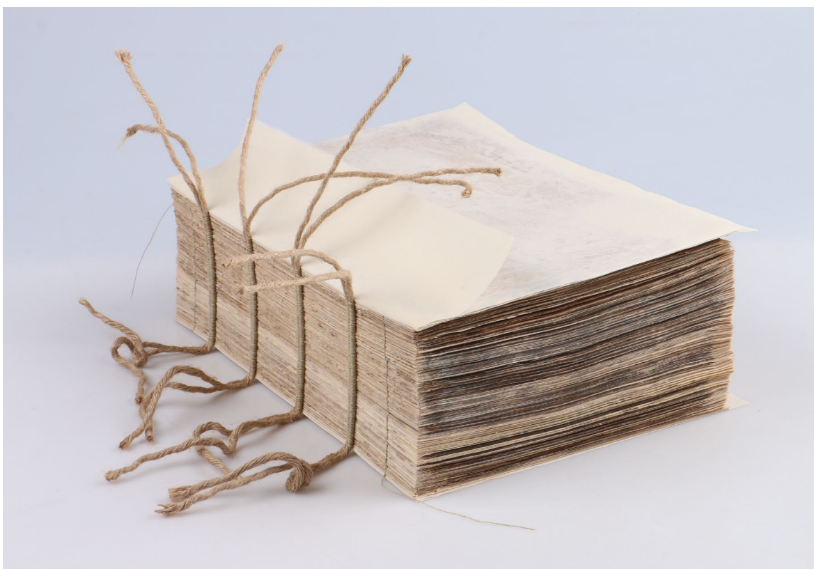
fotografia č. 50 – Knižný blok po ušití a zaglejení chrbtu
