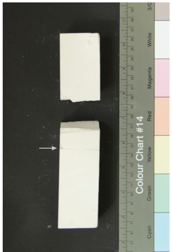
Obr. č. 81 – Rozlomení vzorku mimo lepený spoj (Ponal Super 3)
