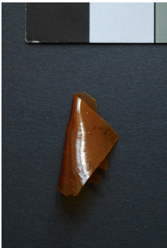
Obr. č. 86 – Film Šelaku po zkoušce zatížení zvýšenou relativní vlhkostí
