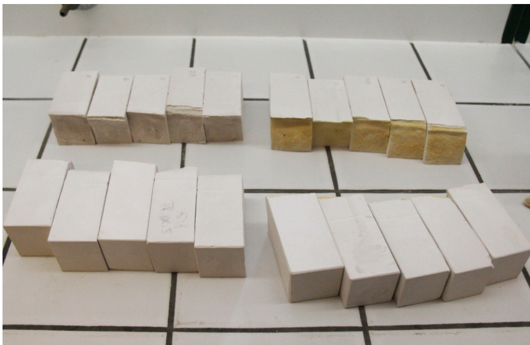
Obr. č. 77 – Rozlomené vzorky opatřené separačním roztokem připravené na slepení
