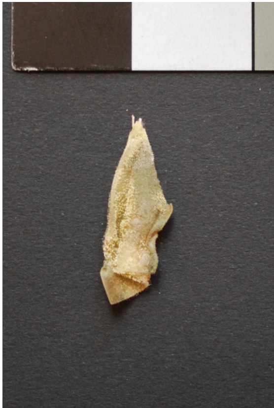
Obr. č. 84 – Film Beva Gelu po zkoušce zatížení zvýšenou relativní vlhkostí
