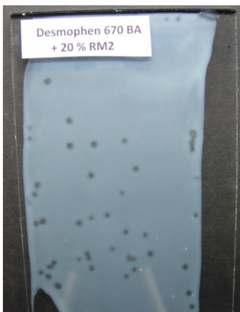
Obrázek 20: Vzhled nátěrového filmu na bázi nátěrového systému tvořeného mikrogelem RM2 20 hm. %, pojivem Desmophen 670 BA a tvrdidlem Desmodur N3390 BA
