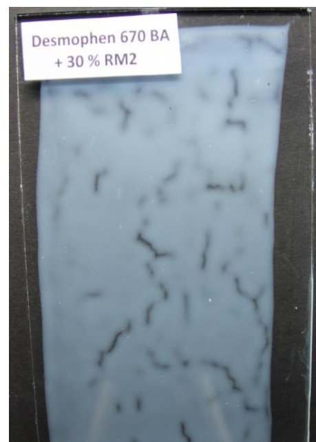
Obrázek 21: Vzhled nátěrového filmu na bázi nátěrového systému tvořeného mikrogelem RM2 30 hm. %, pojivem Desmophen 670 BA a tvrdidlem Desmodur N3390 BA
