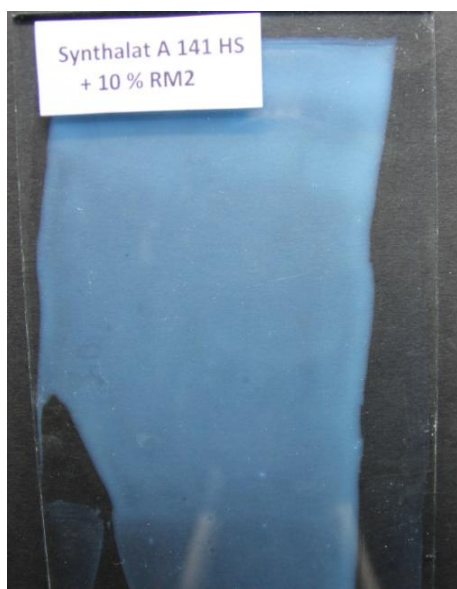
Obrázek 12: Vzhled nátěrového filmu na bázi nátěrového systému tvořeného mikrogelem RM2 10 hm. %, pojivem Synthalat A 141 HS a tvrdidlem Desmodur N3390 BA
