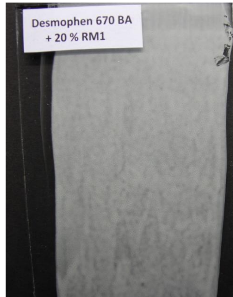
Obrázek 17: Vzhled nátěrového filmu na bázi nátěrového systému tvořeného mikrogelem RM1 20 hm. %, pojivem Desmophen 670 BA a tvrdidlem Desmodur N3390 BA
