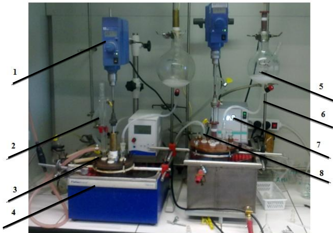
Obrázek 6: Polymerizační aparatura pro přípravu latexu: 1-míchadlo, 2-chladič, 3-reakční nádoba, 4-vodní lázeň, 5-emulgační baňka, 6-přívod monomeru, 7-ponorné ohřívací těleso, 8-přívod inertního plynu
