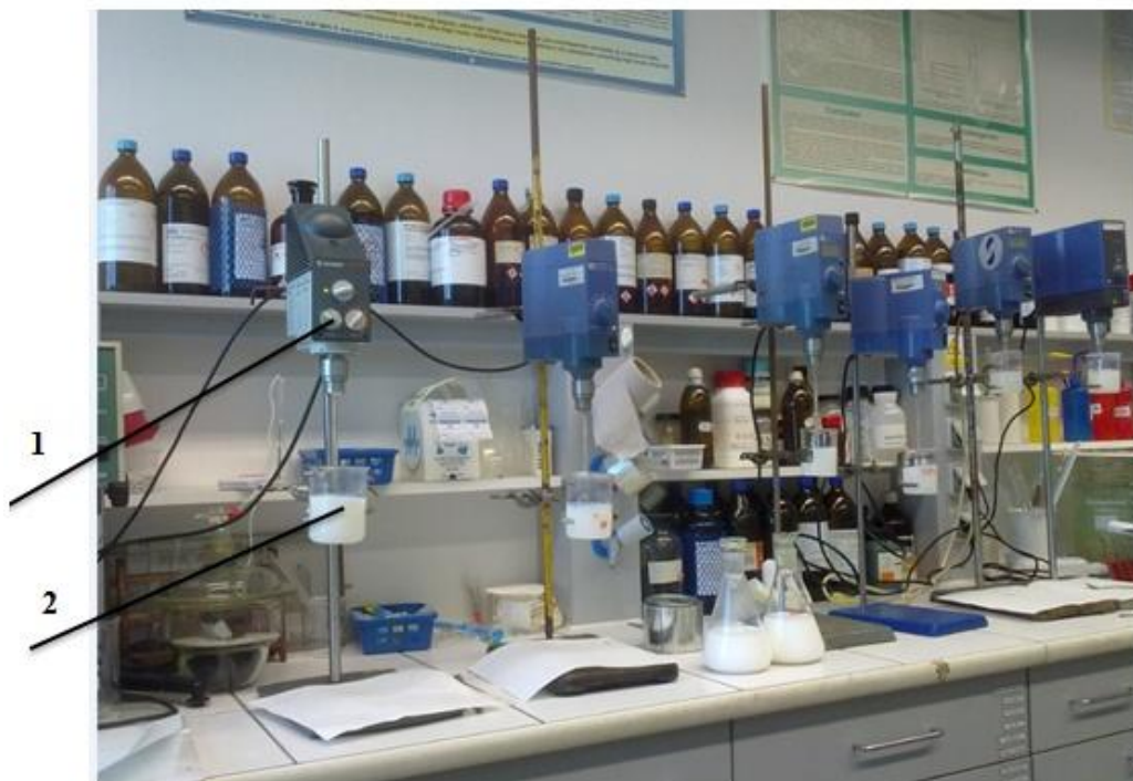
Obrázek 7: Aparatura na zahuštění disperze zbotnalých částic mikrogelů v rozpouštědle MEK: 1-míchadlo, 2-kádinka se zahušťovaným systémem
