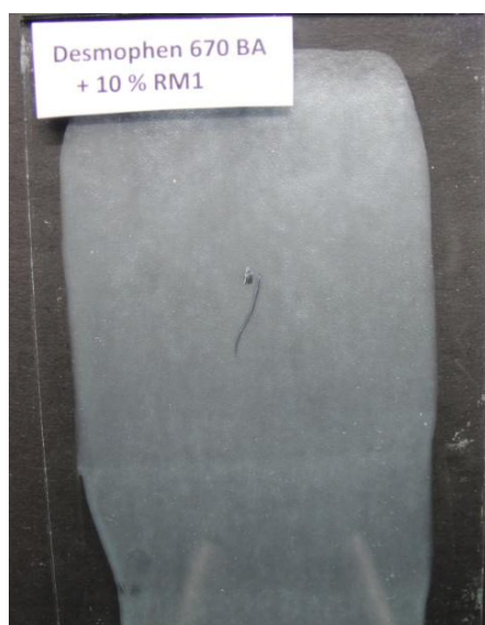
Obrázek 16: Vzhled nátěrového filmu na bázi nátěrového systému tvořeného mikrogelem RM1 10 hm. %, pojivem Desmophen 670 BA a tvrdidlem Desmodur N3390 BA
