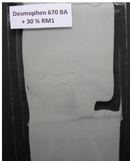
Obrázek 18: Vzhled nátěrového filmu na bázi nátěrového systému tvořeného mikrogelem RM1 30 hm. %, pojivem Desmophen 670 BA a tvrdidlem Desmodur N3390 BA
