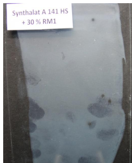
Obrázek 11: Vzhled nátěrového filmu na bázi nátěrového systému tvořeného mikrogelem RM1 30 hm. %, pojivem Synthalat A 141 HS a tvrdidlem Desmodur N3390 BA
