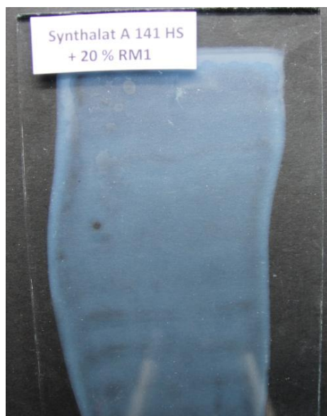
Obrázek 10: Vzhled nátěrového filmu na bázi nátěrového systému tvořeného mikrogelem RM1 20 hm. %, pojivem Synthalat A 141 HS a tvrdidlem Desmodur N3390 BA
