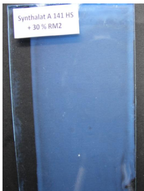
Obrázek 14: Vzhled nátěrového filmu na bázi nátěrového systému tvořeného mikrogelem RM2 30 hm. %, pojivem Synthalat A 141 HS a tvrdidlem Desmodur N3390 BA
