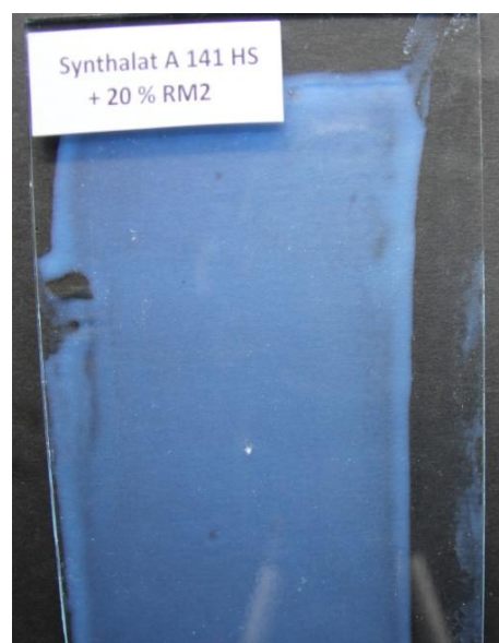
Obrázek 13: Vzhled nátěrového filmu na bázi nátěrového systému tvořeného mikrogelem RM2 20 hm. %, pojivem Synthalat A 141 HS a tvrdidlem Desmodur N3390 BA
