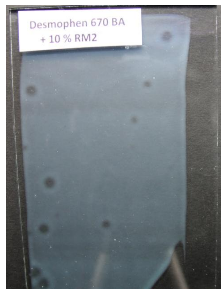
Obrázek 19: Vzhled nátěrového filmu na bázi nátěrového systému tvořeného mikrogelem RM2 10 hm. %, pojivem Desmophen 670 BA a tvrdidlem Desmodur N3390 BA
