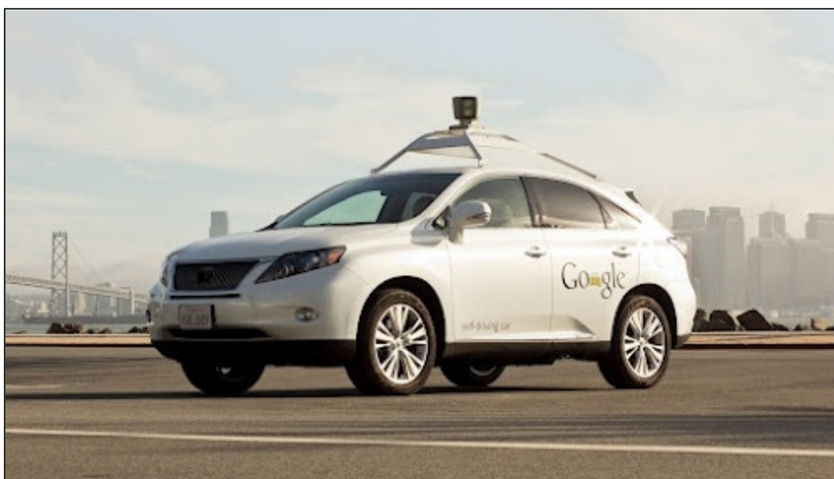
Obrázek 5 - Lexus RX450h - automobil, které dokáže jezdit zcela sám a bez člověka díky technologii Driverless Car od Googlu [převzato z 39]
