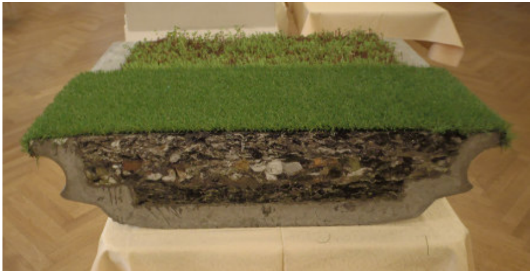
Obrázek č. 18 – řez vnitřním dílcem kolejového absorbéru ze syntetického recyklátu, v přední části s povrchem z umělého trávníku, v zadní části živý trávník s podkladní humózní vrstvou (zdroj:foto autor)
