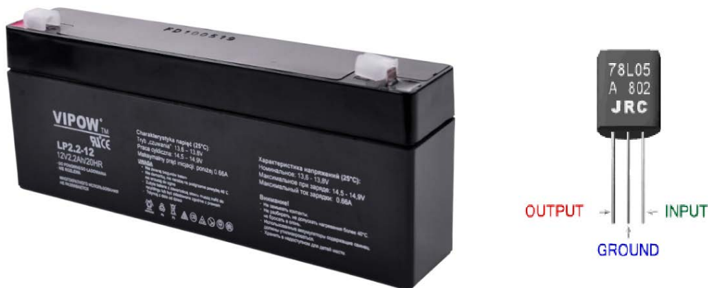
Obr. 3.10 – 12 V akumulátor a lineární regulátor 78L05
