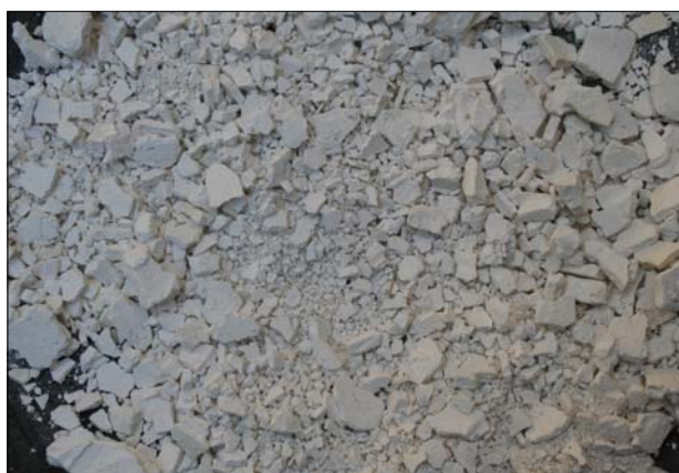
Obr. 119 Ztuhlé drcené hašené vápno.
