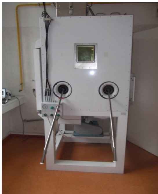
Fotografie 11 Digestoř pro přípravu roztoku ^{131}\text{I}
