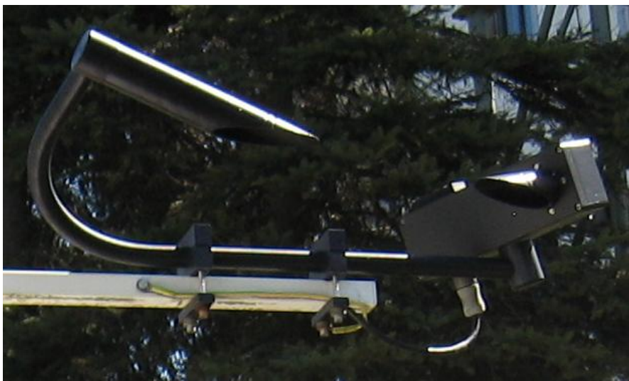
Obr. 14 Dohledoměr Vaisala PWD21 na Milešovce
