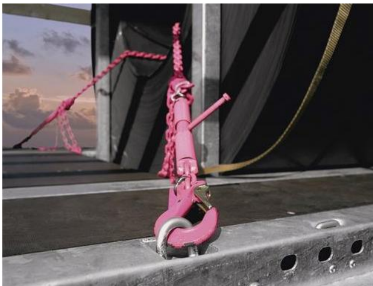
Obrázek 19 – Zajištění těžkého svitku plechu řetězy [9]
