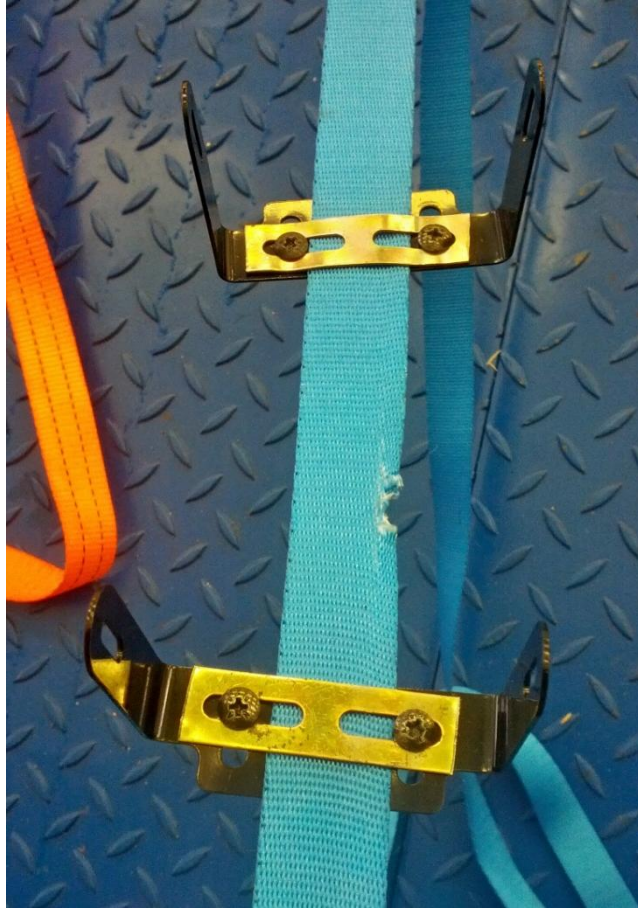
Obrázek 3 – Roztažení naříznutí při zatížení popruhu
