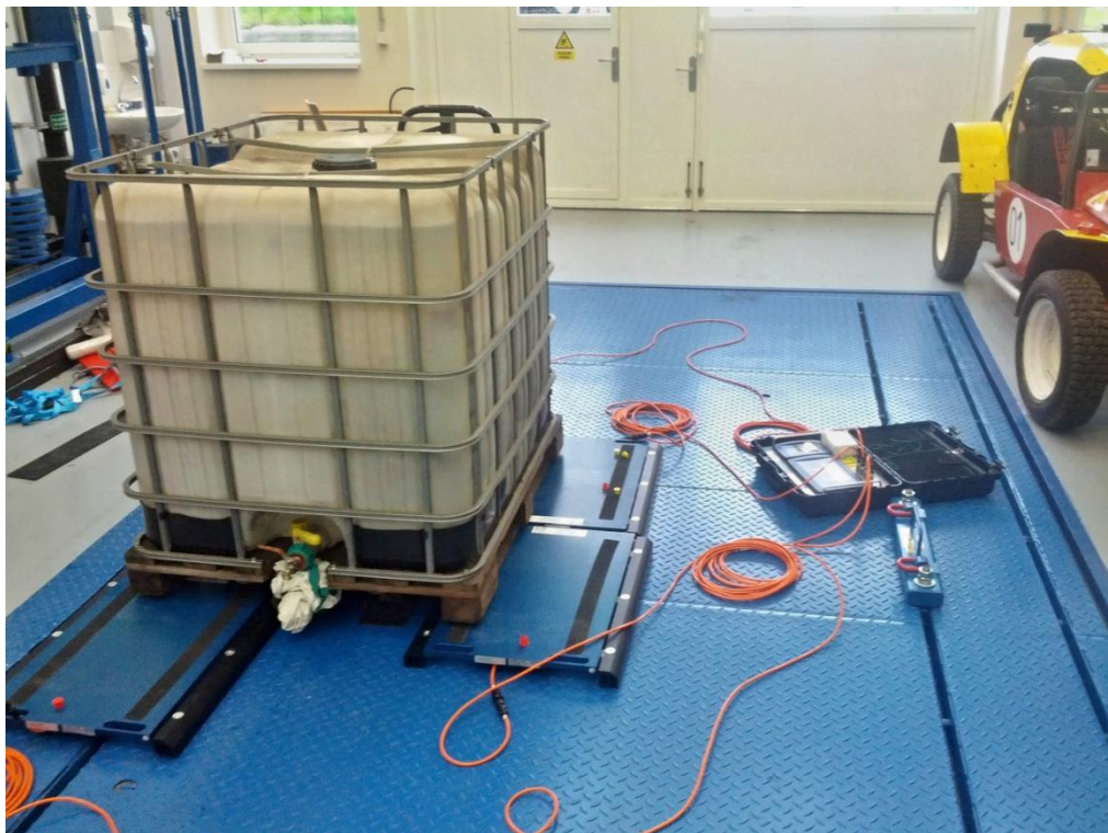
Obrázek 4 – Měření hmotnosti IBC kontejneru
