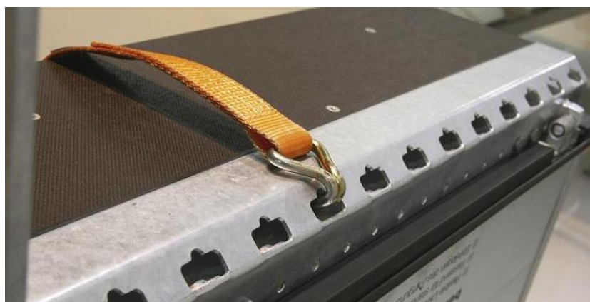
Obrázek 15 – Variabilní kotevní systém [9]
