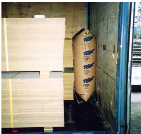
Obrázek 24 – Vyplnění mezery v kontejneru vzduchovým vakem [5]
