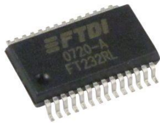
Obr. č. 5.2 – čip FT232RL. Přejato z https://solarbotics.com/product/17211/ (19. 5. 2014)
