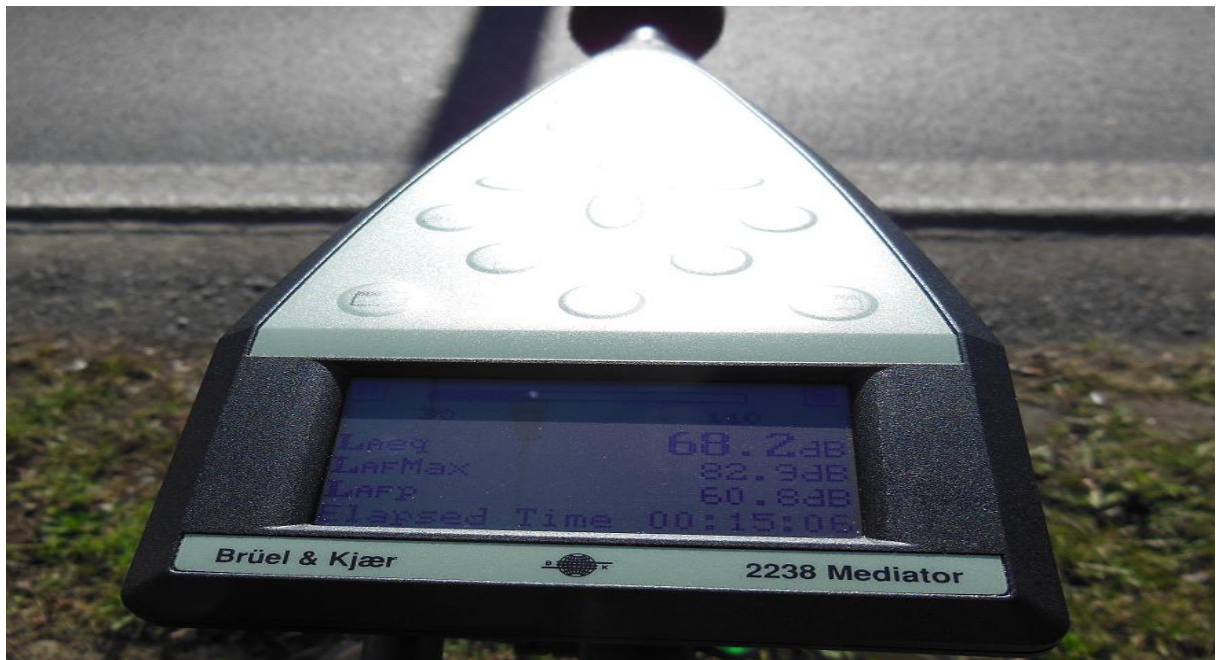
Obrázek 15 Měřicí přístroj Mediator 2238 – zobrazené hodnoty akustického tlaku (foto autor)
