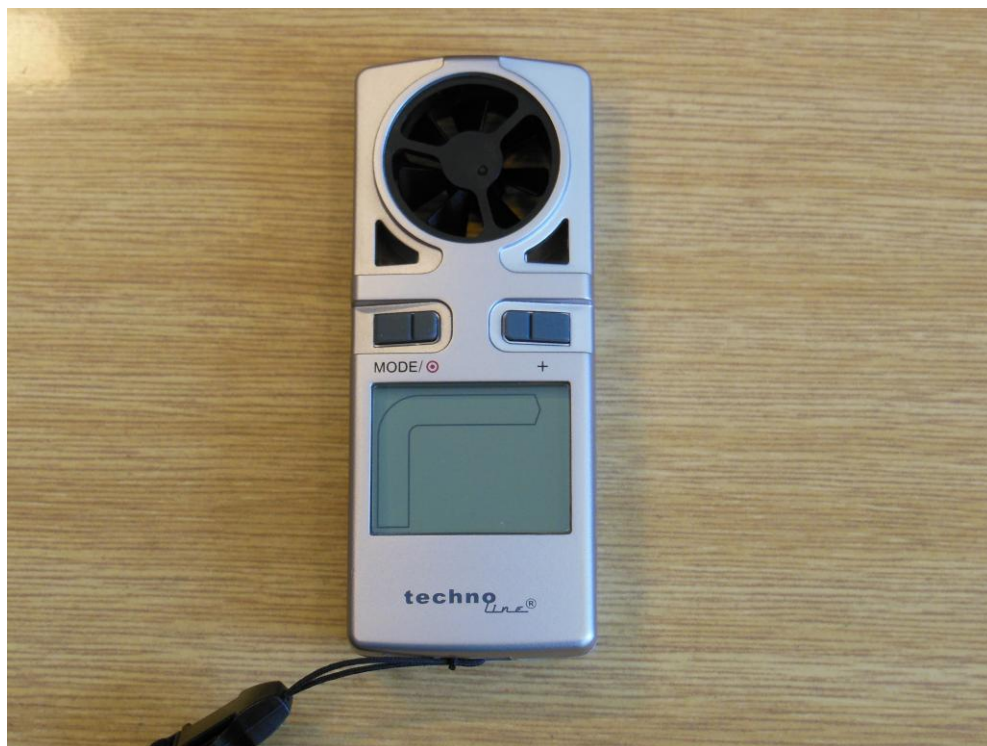
Anemometr TECHNO pro měření rychlosti větru a teploty okolního vzduchu
